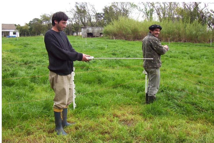
Anexo 04 – Leitura da medida de IL do pasto com auxílio de ceptômetro lineal.
