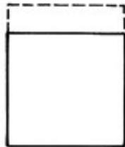
FIGURA 20 – EFEITO DA VARIAÇÃO DE VELOCIDADE DA PLATAFORMA NA IMAGEM – ADAPTADO DE RICHARDS & JIA (2006)
