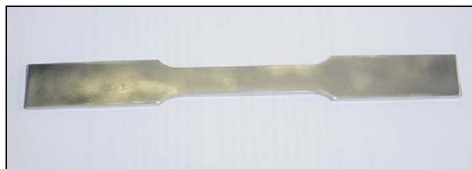
Figura 17 – Foto do corpo de prova usado para o ensaio de tração
