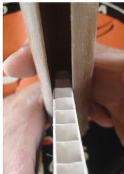
**Figura A25 – Encaixando a placa de PVC no tubo**
