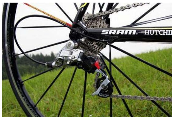
**Figura 81 – Câmbio traseiro do tipo descarrilhador**
