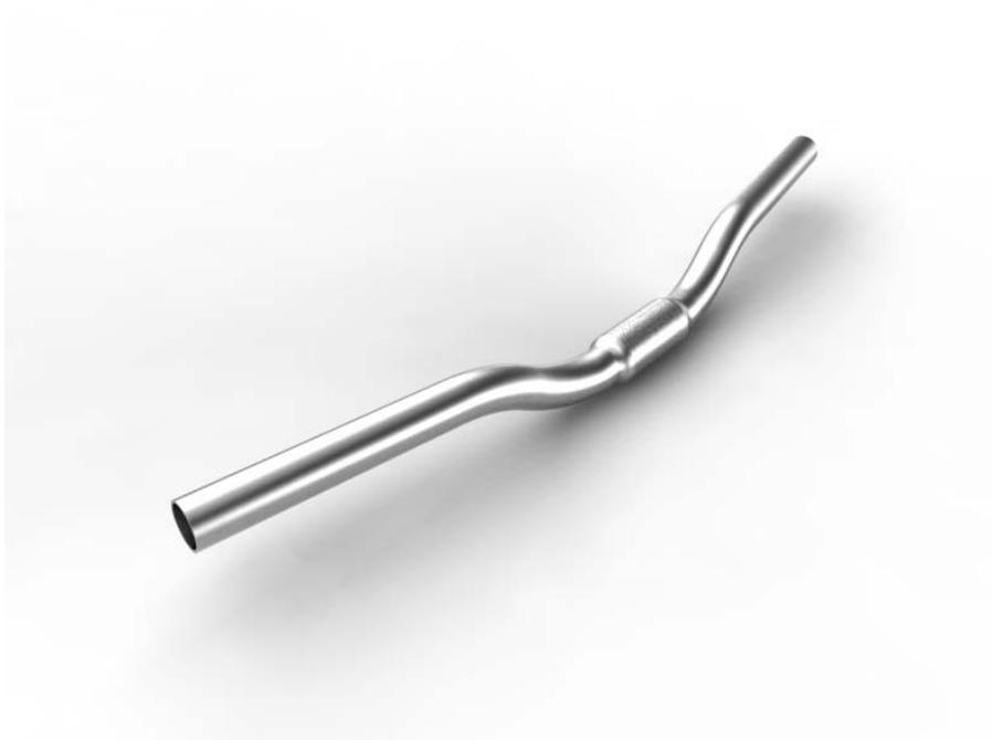
**Figura 115 – Guidão tipo *riser* desenvolvido no projeto**
