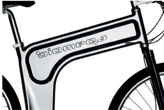
Figura 61 – Quadro produzido em alumínio utilizando a técnica *Superplastic Forming*. Fonte: Biomega, 2010
