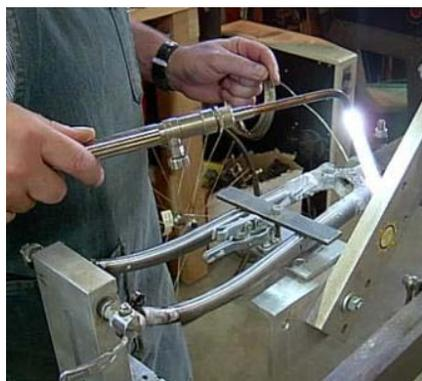
**Figura 63 – Brasagem de tubos e *lugs* metálicos**
