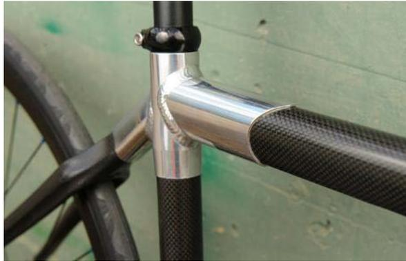
**Figura 58 – Bicicleta com tubos de Fibra de Carbono e *lugs* de Alumínio**
