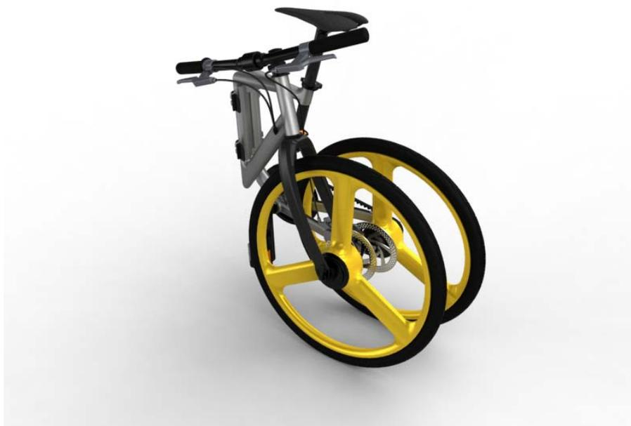
**Figura 123 – Bicicleta desenvolvida em posição dobrada, perspectiva posterior**
