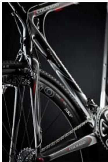
**Figura 59 – Quadro com tubos e *lugs* de Fibra de Carbono**
