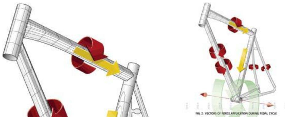
Figura 62 – Vetores de força aplicados durante o ciclo de pedalada
