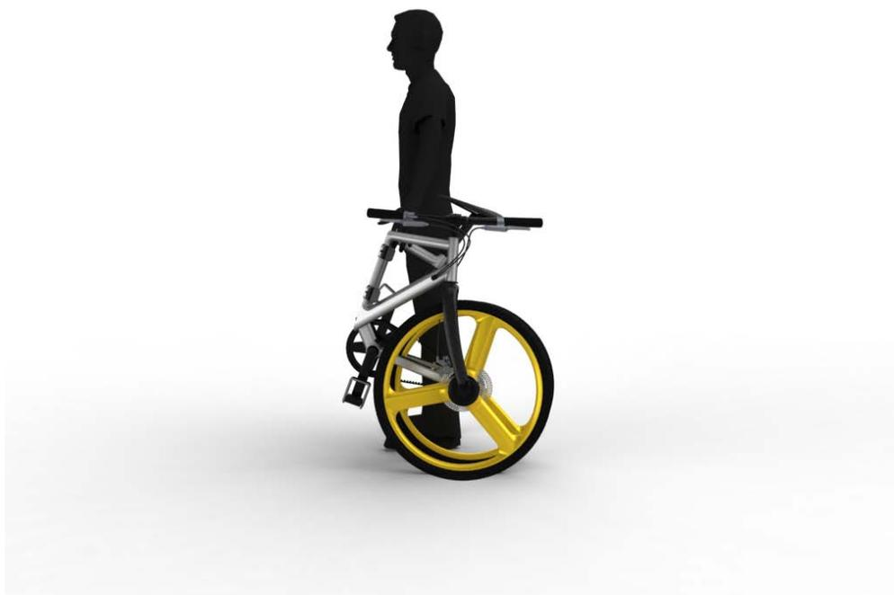
**Figura 127 – Simulação do transporte da bicicleta dobrada**
