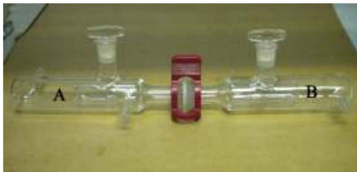
**Figura 13:** Célula de difusão para determinação da permeabilidade.
