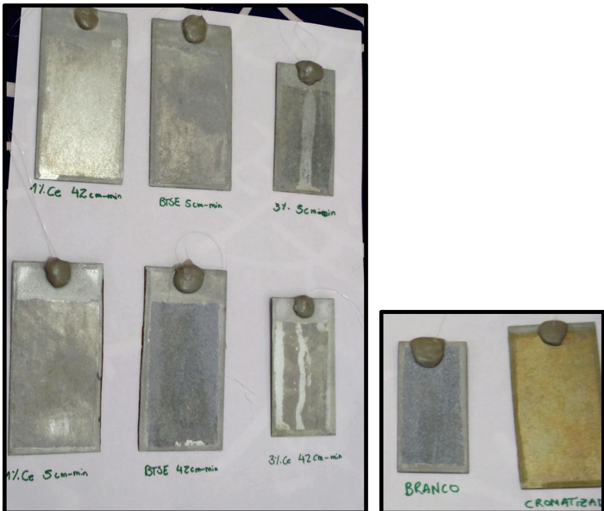
Figura 62 - Fotografia das amostras BTSE dopado com diferentes concentrações de Ce após 168h em câmara úmida.
