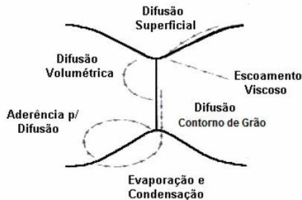
Figura 6 - Diferentes mecanismos de movimento atômico durante o processo de difusão (Coutinho, 2007).
