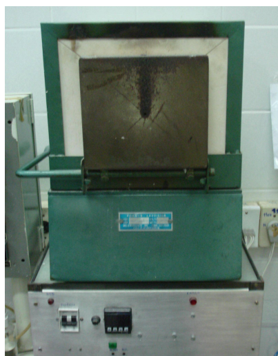
Figura 20 - Forno resistivo da marca Lavoisier utilizado para o ensaio de choque térmico.
