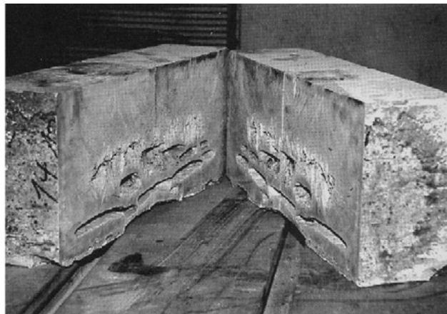
Figura 2 - Tijolo refratário de mulita fundida frequentemente utilizado em tanques de fundição de vidro (Schneider, 2007).
