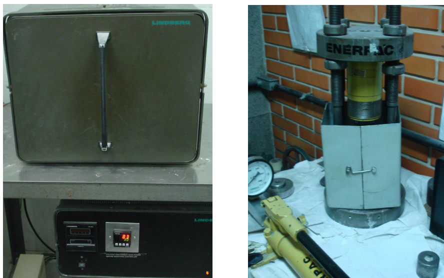
Figura 15 - a) Forno resistivo utilizado para a sinterização dos corpos de prova. b) Prensa hidráulica uniaxial utilizada para a prensagem dos corpos de prova.
