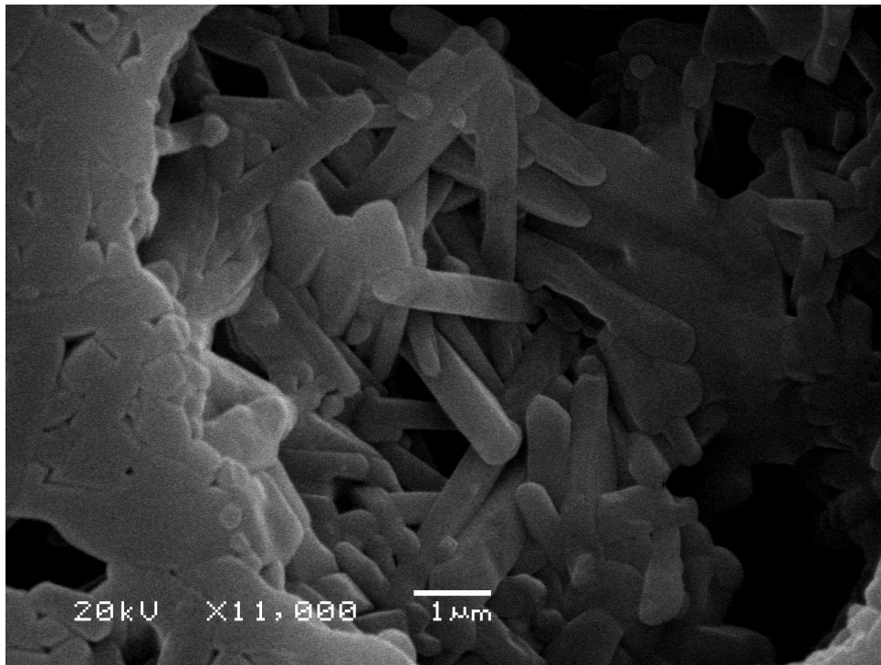
Figura 31 - Micrografia da superfície polida dos corpos sinterizados a 1600°C mostrando o formato acicular dos grãos, aumento 11000X (Rota 1).
