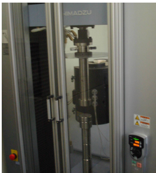
Figura 18 - Máquina Universal de Ensaios da marca Shimadzu utilizada no ensaio de flexão em quatro pontos.
