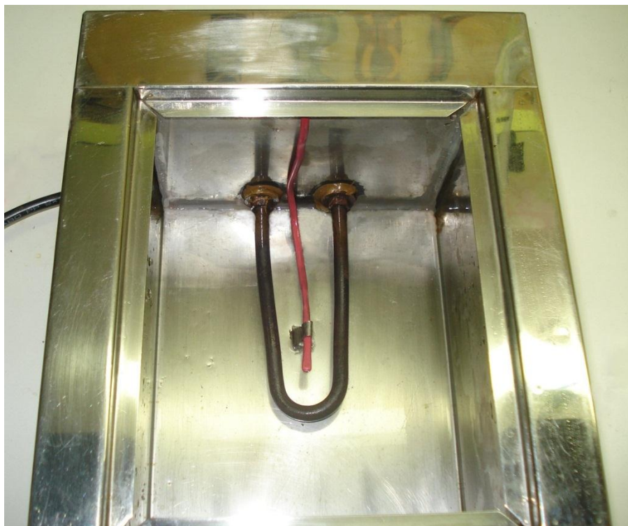
Figura 3.1– Ilustração da resistência de aquecimento e sensor de temperatura
