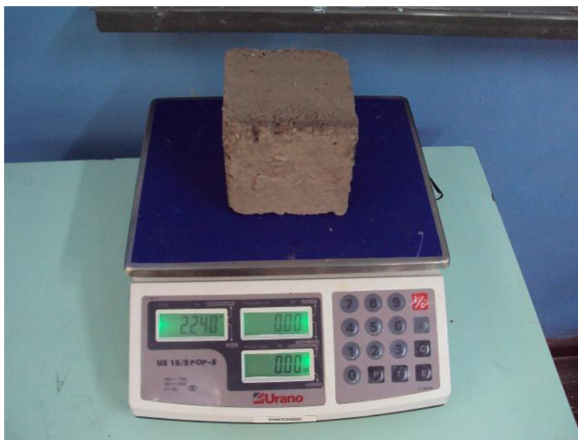
Figura 27: Pesagem do bloco de concreto: 2240 g
