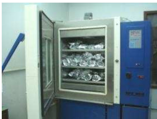
Figura 4.7: Sazonamento dos corpos de prova em ambiente controlado.
