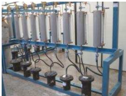
Figura 4.17: Ensaio de permeabilidade.
