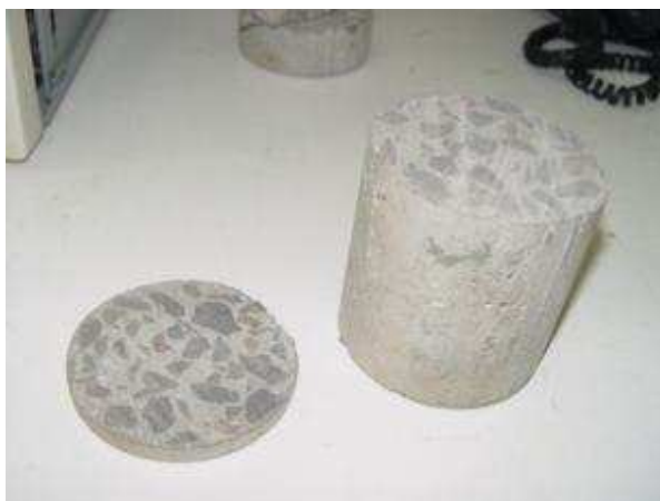
Figura 4.10: Extração de cilindros do corpo de prova após a exposição ao calor.
