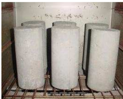
Figura 4.5: Determinação da massa saturada e seca por secagem em estufa.
