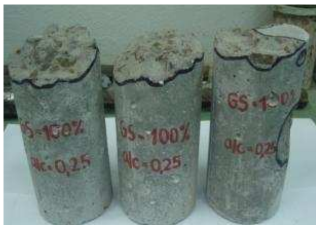
Figura 4.21: Inspeção visual dos corpos de prova e marcação das fragmentações explosivas.
