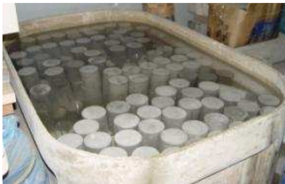
Figura 4.4: Cura dos corpos de prova em tanque com água e cal.
