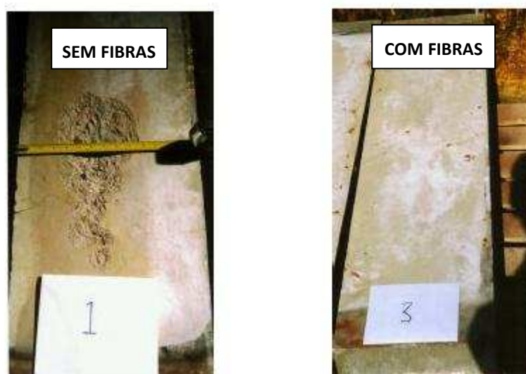
Figura 2.24: Atuação da fibra de polipropileno na redução do lascamento explosivo (Khoury e Anderberg, 2000).
