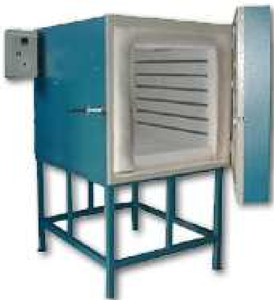
Figura 4.19: Forno elétrico utilizado nos ensaios em altas temperaturas.
