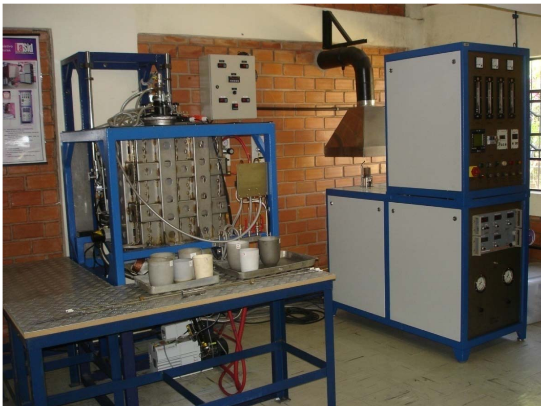
Figura 18 – Foto do forno elétrico resistivo HT-2100-Vac-Graphit-Special da LINN High Therm — LASID – UFRGS
