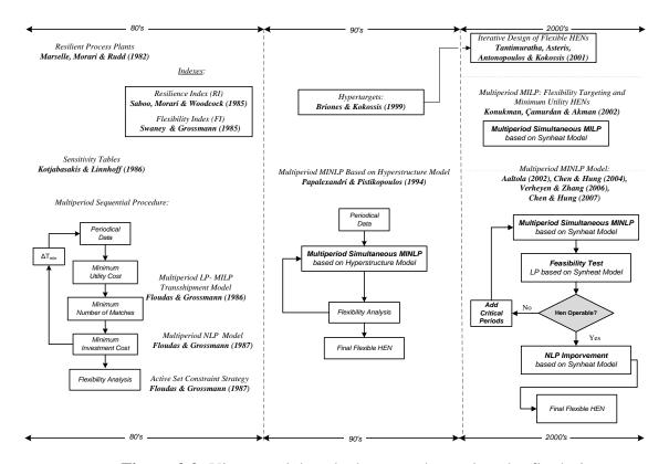
Figura 2.2: Visão geral de métodos para síntese de redes flexíveis
