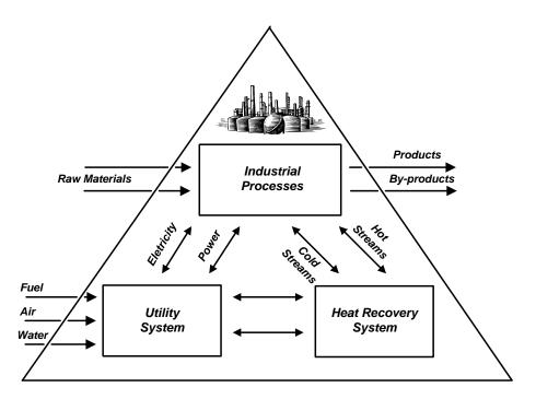
Figura 1.1: Sistema geral de processo.
