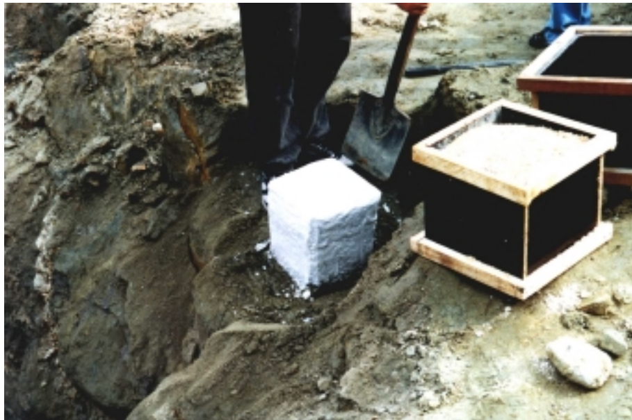
Figura 3.5 – Cobertura de parafina no bloco de solo para posterior acondicionamento em caixa de madeira.
