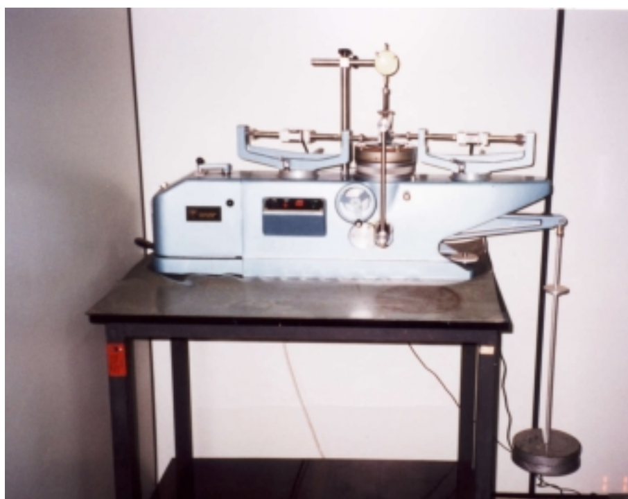
Figura 4.2 – Equipamento ring shear utilizado.
