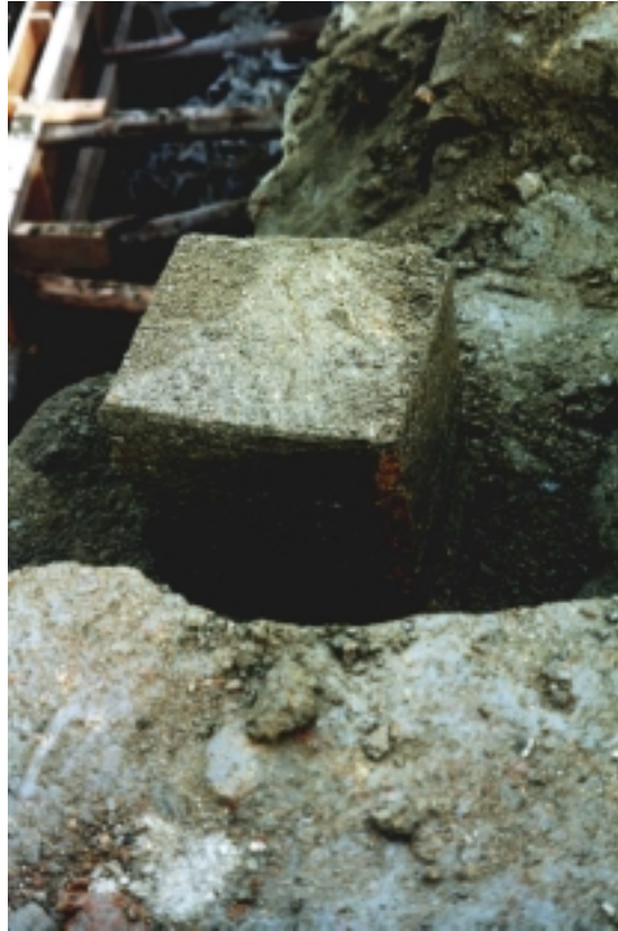
Figura 3.4 – Moldagem do bloco indeformado de solo residual de gnaiss.
