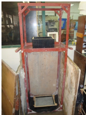
Figura 21: caixa de queda
