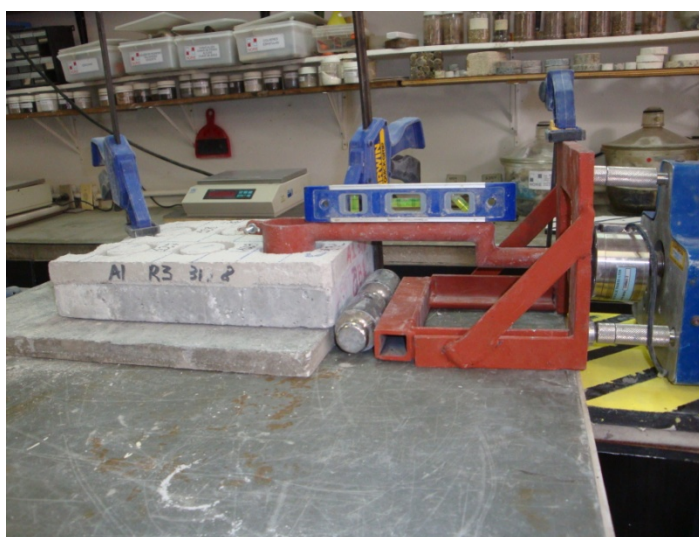
Figura 82: ilustração da forma de execução do ensaio de resistência de aderência ao cisalhamento
