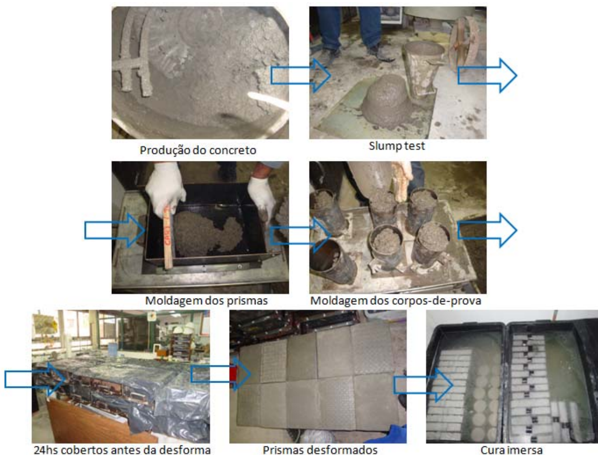
Figura 19: passo-a-passo da produção dos substratos de concreto
