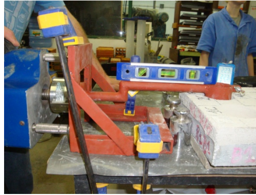
Figura 92: nivelamento do dispositivo
