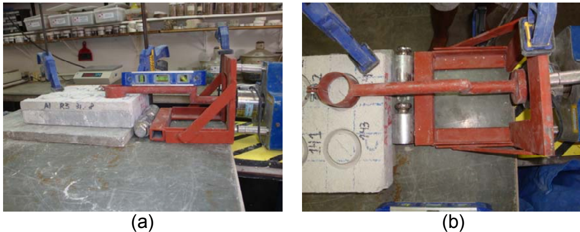
Figura 26: execução do ensaio de resistência de aderência ao cisalhamento (a) vista geral (b) detalhe da fixação do equipamento do CP
