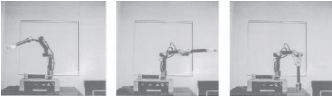
Figura 2.2 – Manipulador antropomórfico com três graus de liberdade, adaptado de Bobrow e McDonell, 1998
