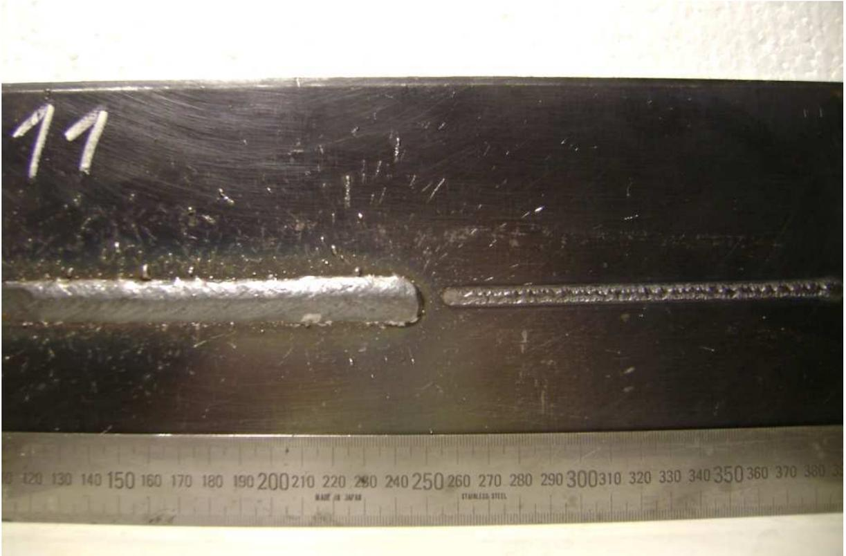
Figura A.18 – Cordões de solda do experimento 11 pelos processos TIG convencional e MAG convencional.
