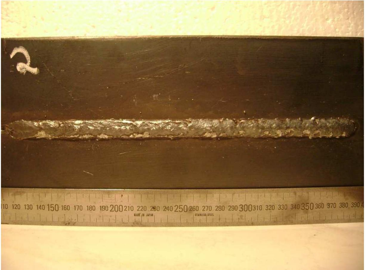
Figura A.1 – Cordão de solda do experimento 02 pelo processo TIG e MAG em tandem.
