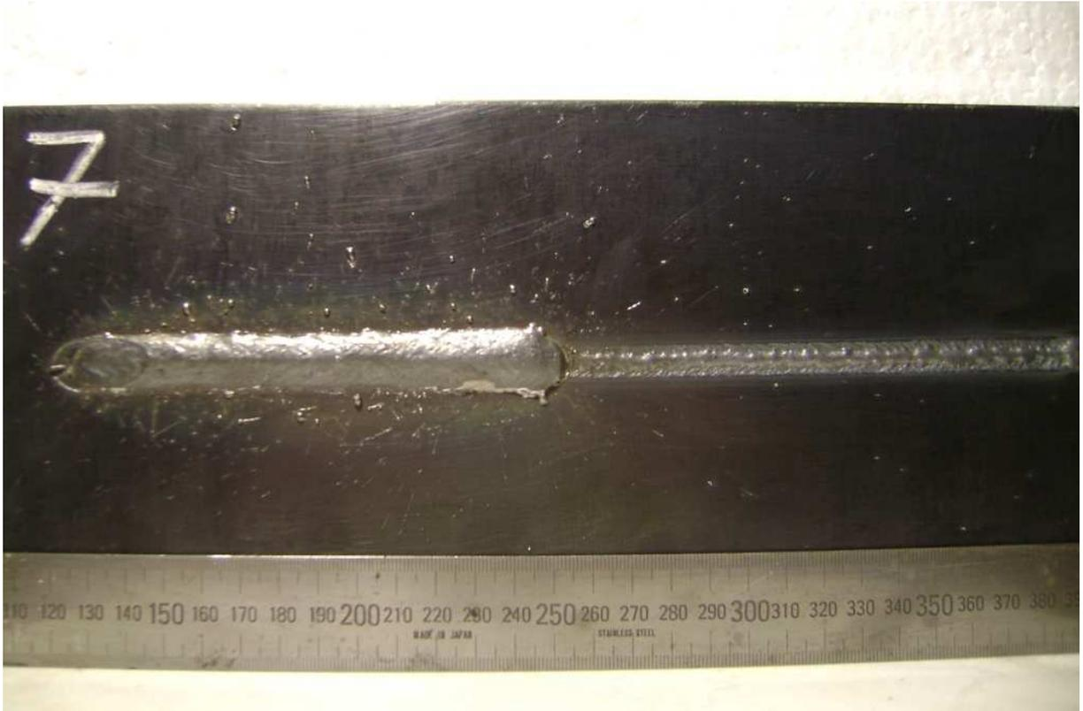
Figura A.13 – Cordões de solda do experimento 07 pelos processos TIG convencional e MAG convencional.
