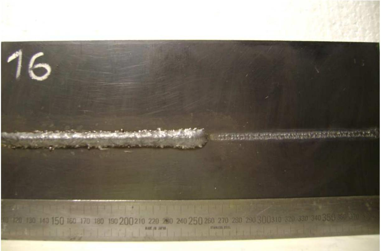
Figura A.23 – Cordões de solda do experimento 16 pelos processos TIG convencional e MAG convencional.
