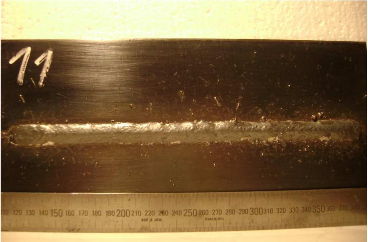
Figura A.16 – Cordão de solda do experimento 11 pelo processo TIG e MAG em tandem.
