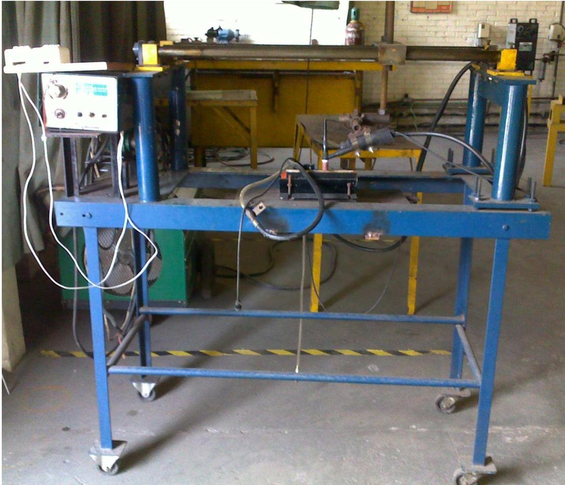
Figura 4.2 – Bancada de soldagem mecanizada.
