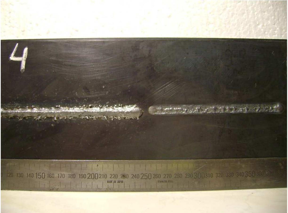
Figura A.8 – Cordões de solda do experimento 04 pelos processos TIG convencional e MAG convencional.
