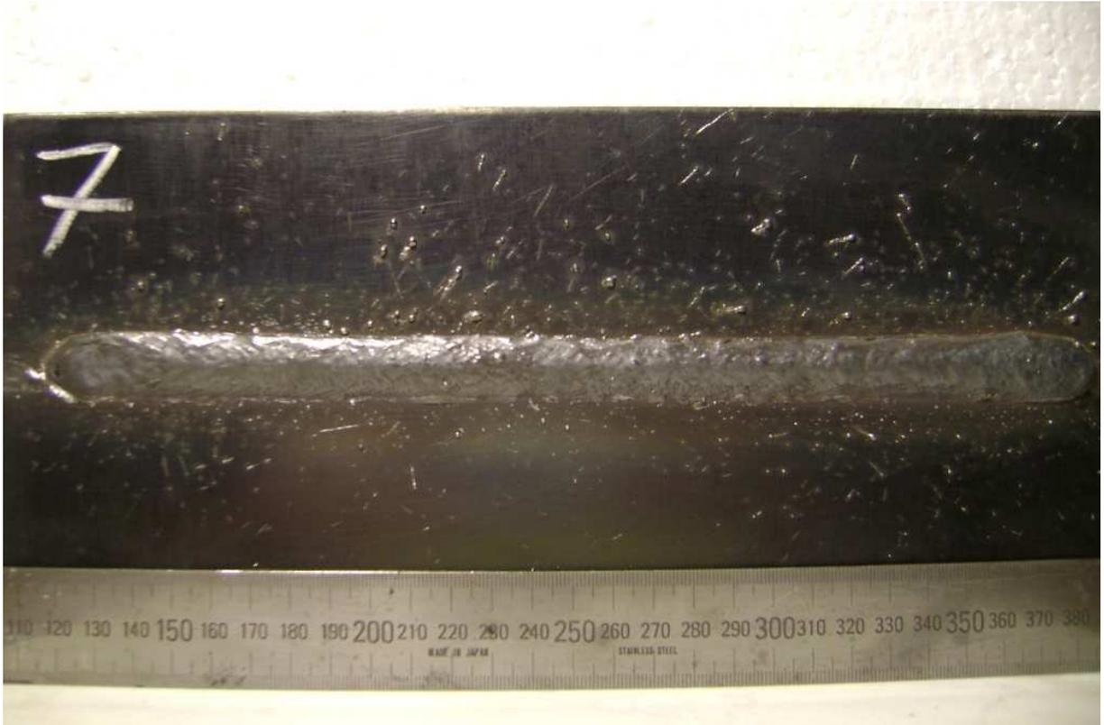
Figura A.11 – Cordão de solda do experimento 07 pelo processo TIG e MAG em tandem.
