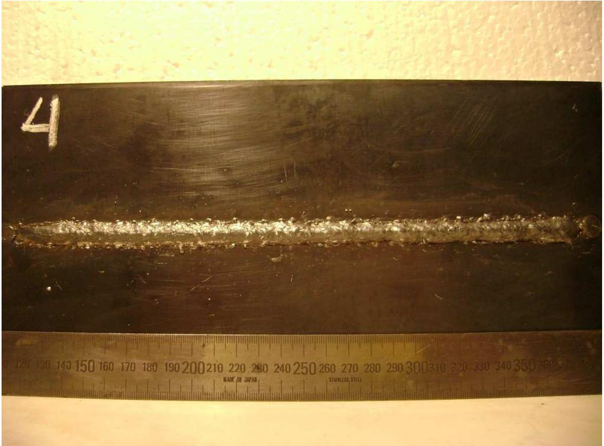
Figura A.6 – Cordão de solda do experimento 04 pelo processo TIG e MAG em tandem.
