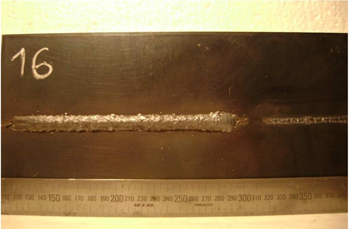
Figura A.21 – Cordão de solda do experimento 16 pelo processo TIG e MAG em tandem.
