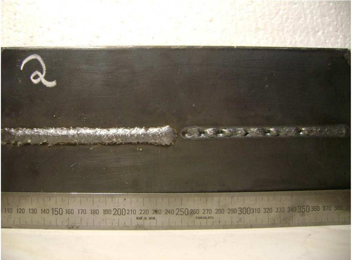
Figura A.3 – Cordões de solda do experimento 02 pelos processos TIG convencional e MAG convencional.
