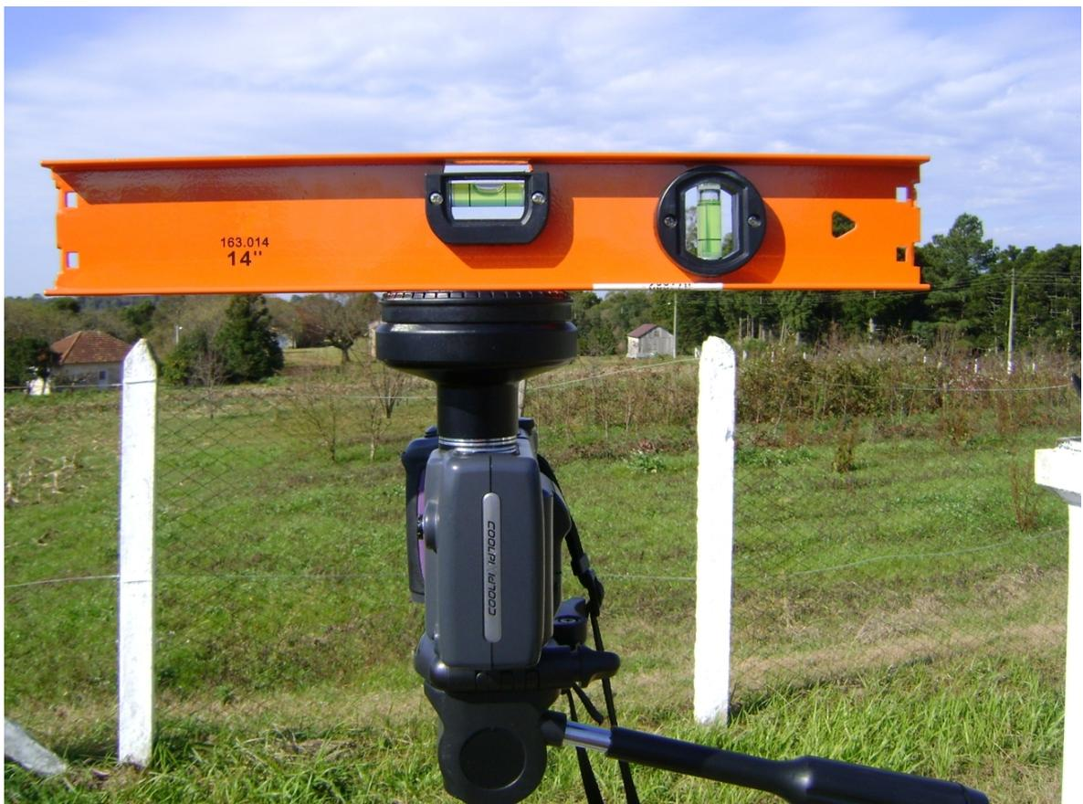
FIGURA 24. Nivelamento do equipamento para obtenção das fotografias hemisféricas.
