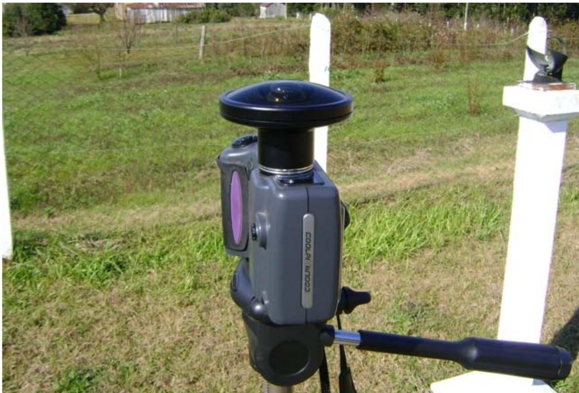
FIGURA 11. Conjunto de câmera fotográfica e lente grande angular, montado sobre tripé.
