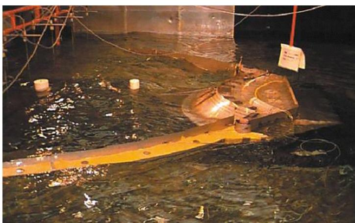
Figura 3.14: Wave Dragon. Protótipo em testes no laboratório.
