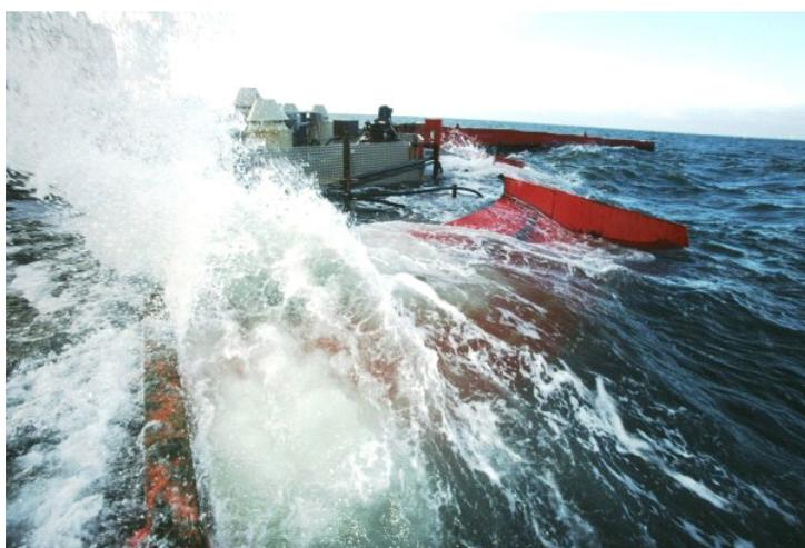
Figura 3.15: Wave Dragon. Protótipo em testes no mar.
