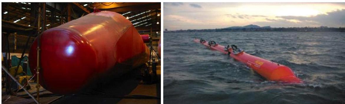
Figura 3.11: Protótipo de 750 kW em construção e operando em alto mar.
