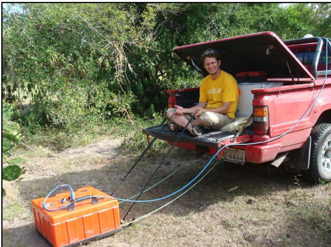
**Fig. 16 - Procedimento para a obtenção dos perfis de GPR realizados com o auxílio de um veículo.**
