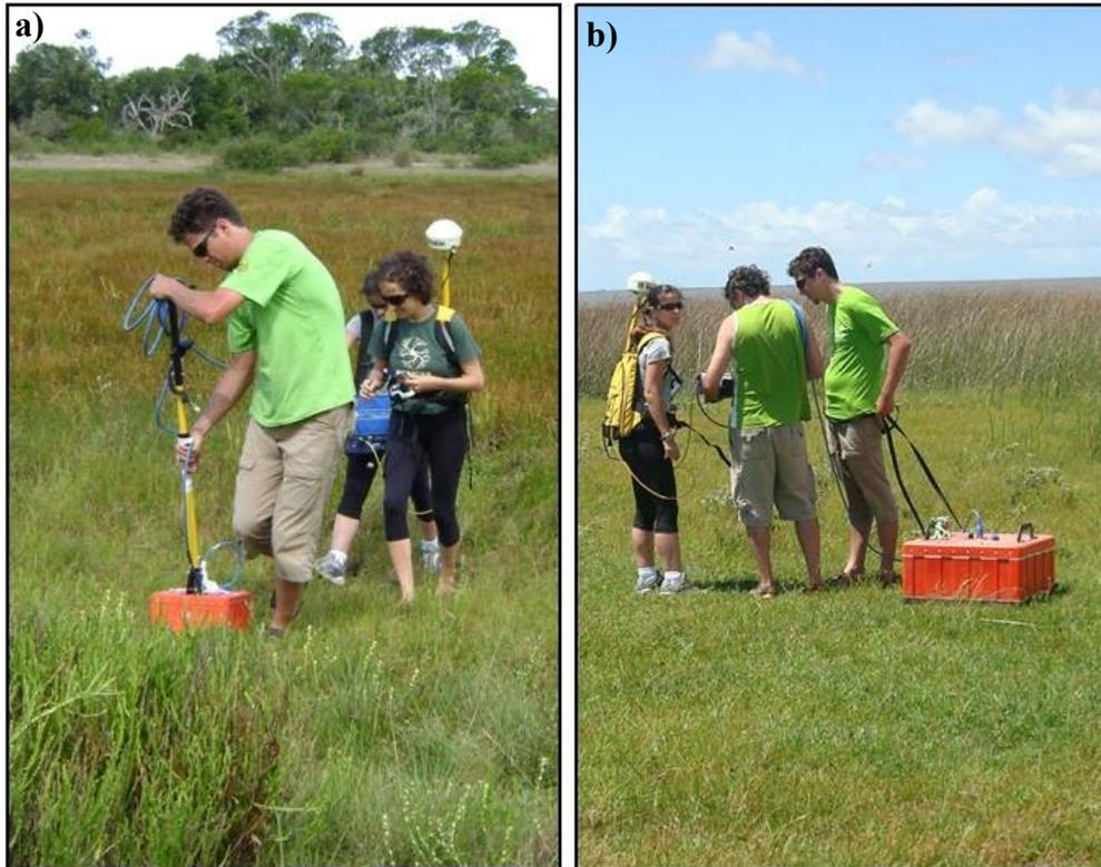
**Fig. 15 - Procedimento para obtenção dos perfis de GPR realizados caminhando. Em a) com a antena de 400 MHz e em b) com a antena de 200 MHz.**
