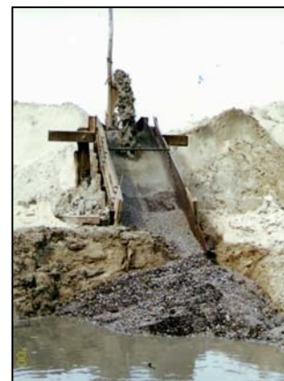
FIGURA 53 – Rejeito grosseiro à frente da peneira no pátio de estocagem.
