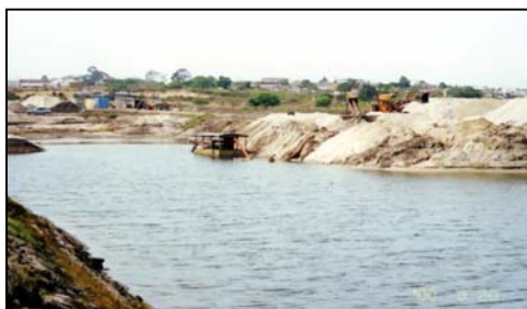
FIGURA 49 – Dragagem e duto conectados em atual cava de exploração.
