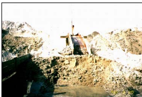
FIGURA 47 – Estrutura (ducto e peneira) para o segundo beneficiamento da Lavra em Leito de Rio.
