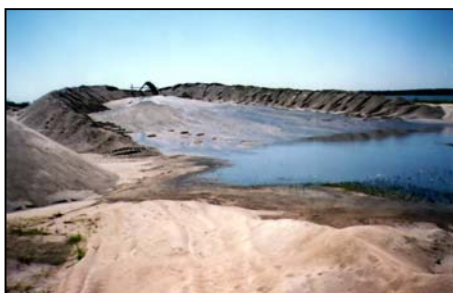
FIGURA 52 – Rejeito fino obtido no método da Lavra em Leito de Rio.
