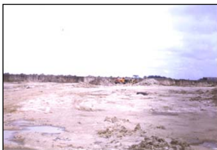
FIGURA 56- Extração da argila na jazida coletiva. Observa-se a profundidade da extração em relação à altura do caminhão.
