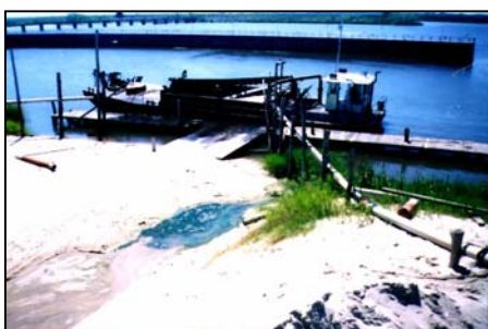
FIGURA 45 – Embarcação (draga) utilizada no método da Lavra em Leito de Rio.
