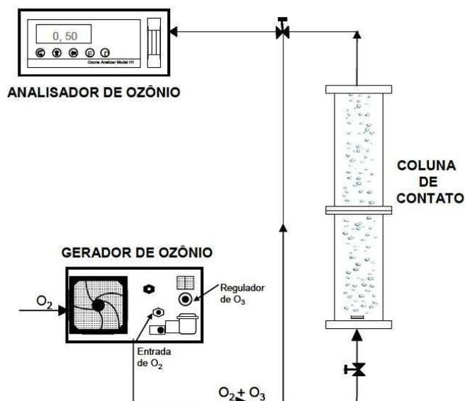
**Figura 8.** Esquema da unidade de ozonização, alimentada com oxigênio.
