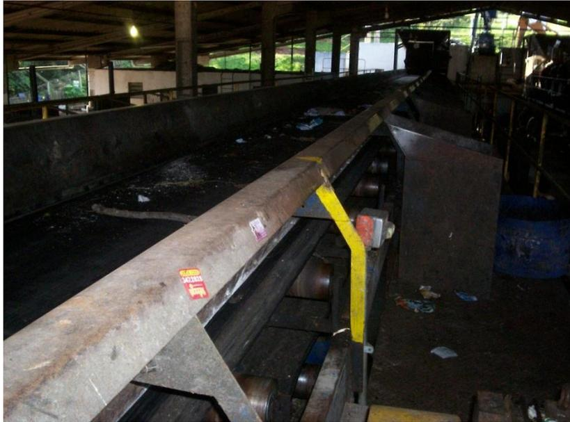
Figura 6: Esteira de triagem mecanizada.
