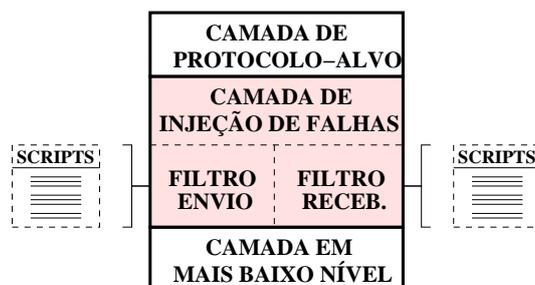
Figura 2.4: Injeção de falhas por inserção de camada na pilha de protocolos.
