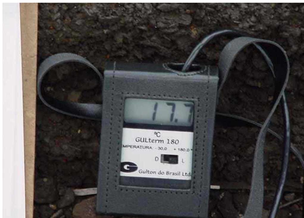
**FIGURA 5.6** – Termômetro usado para medir a temperatura no revestimento
