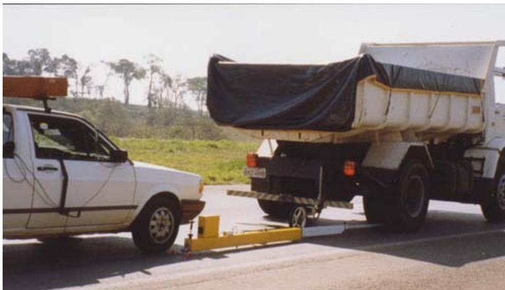
**FIGURA 5.2 – Defletógrafo Digital (Viga Eletrônica)**
