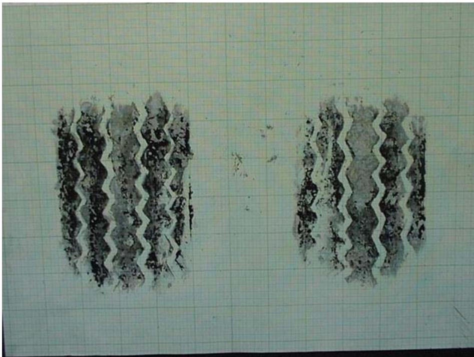
**FIGURA 4.11** – Impressão dos pneus para carga de eixo de 82 kN
