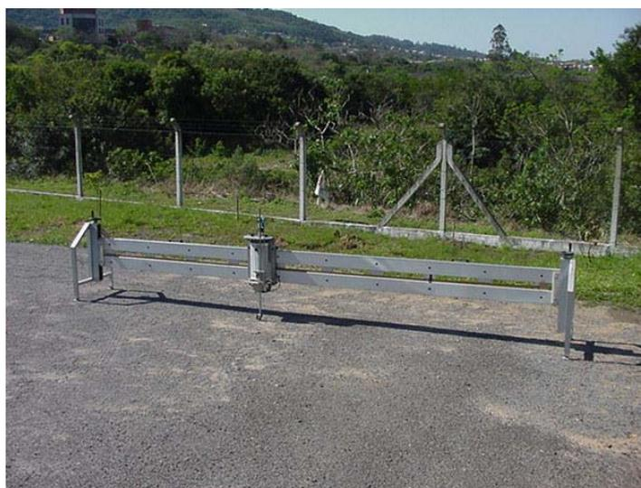
**FIGURA 5.4** – Perfilógrafo usado para medir a deformação permanente que ocorreu no pavimento.
