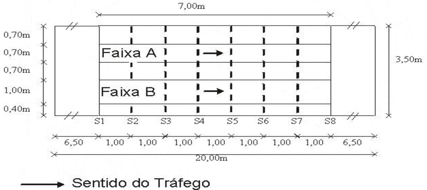
FIGURA 4.16 – Representação da Pista Experimental com as dimensões das faixas solicitadas
