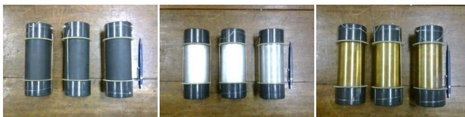
Figura 29: Tubos de Bi-2223, alumínio e latão utilizados no ensaio.
