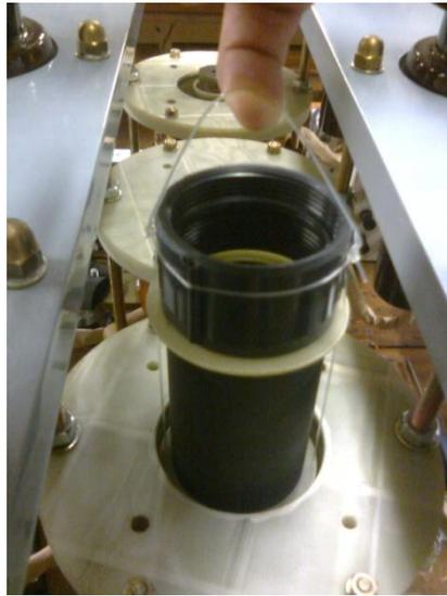
Figura 20: Secundário supercondutor sendo instalado no criostato.
