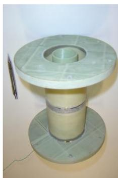
Figura 15: Criostato utilizado para acondicionar o tubo supercondutor.
