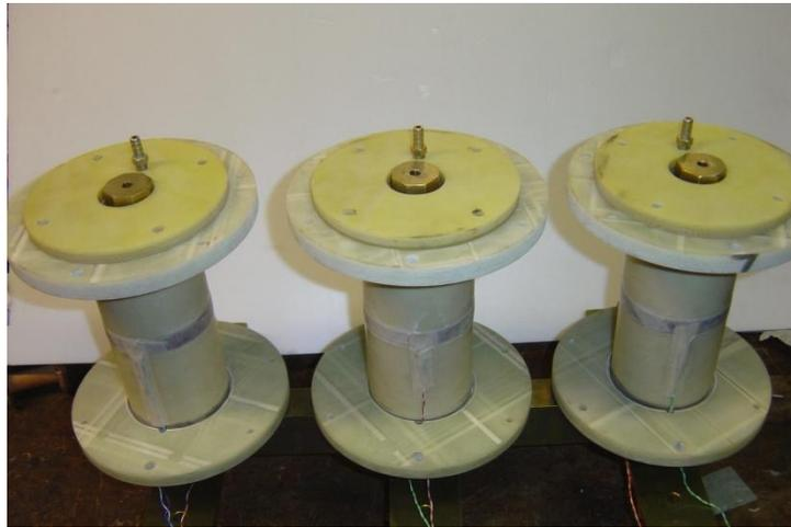
Figura 16: Criostatos instalados no núcleo com bobinas exploradoras externas expostas.
