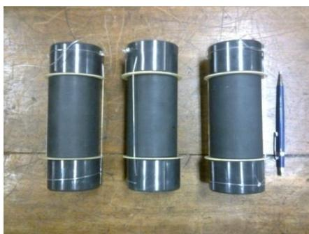
Figura 19: Tubos supercondutores em estruturas para instalação no limitador
