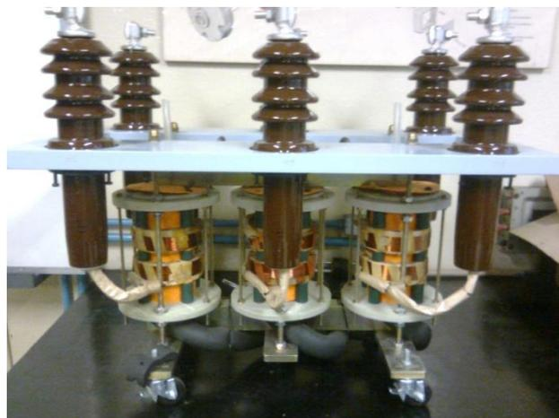
Figura 21: Foto do limitador de corrente supercondutor, objeto de ensaio, completo.
