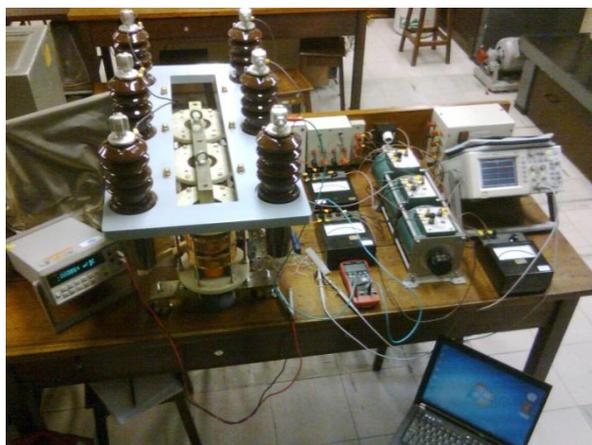
Figura 30: Foto da montagem para ensaio em regime permanente.
