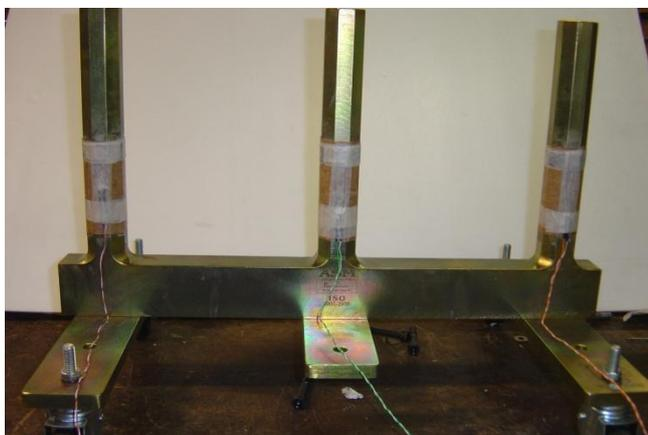
Figura 14: Núcleo maciço com bobinas exploradoras internas já instaladas
