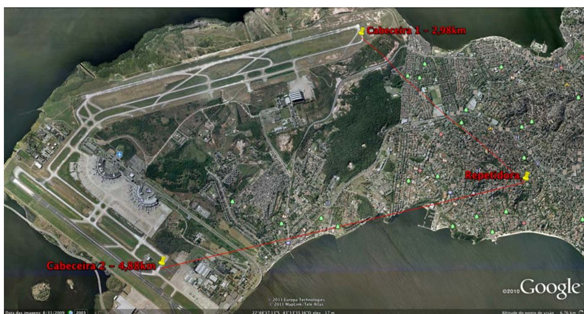
Figura 19: Distância entre a repetidora e as cabeceiras do aeroporto Galeão
