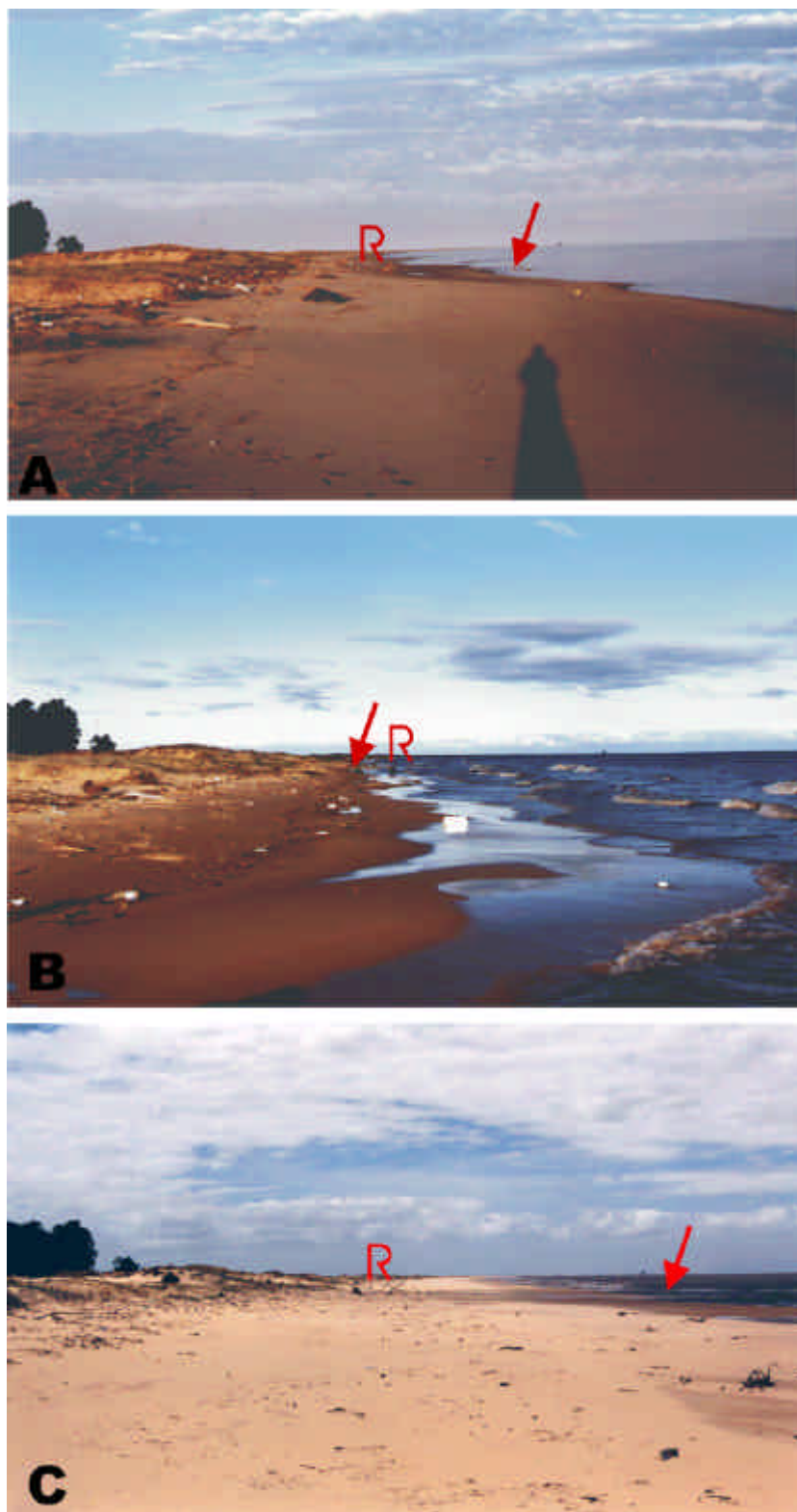
Figura 16. Comparação da largura da face praial em dezembro de 2000 (A), maio de 2001 (B) e julho de 2001 (C). A seta vermelha indica a posição da linha d'água e a letra R representa o ponto de referência.
