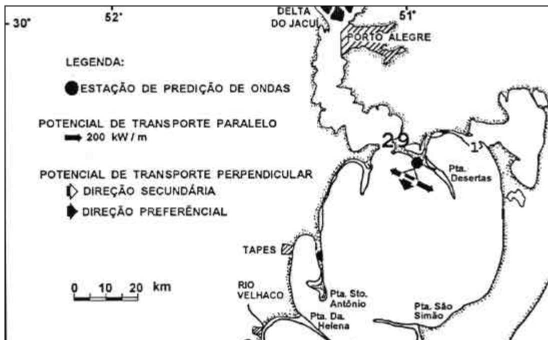
Figura 45: Distribuição do potencial de transporte sedimentar paralelo e perpendicular a praia para o ano de 1988, segundo TOLDO (1994). A Praia de Fora equivale à estação de previsão de ondas 29.
