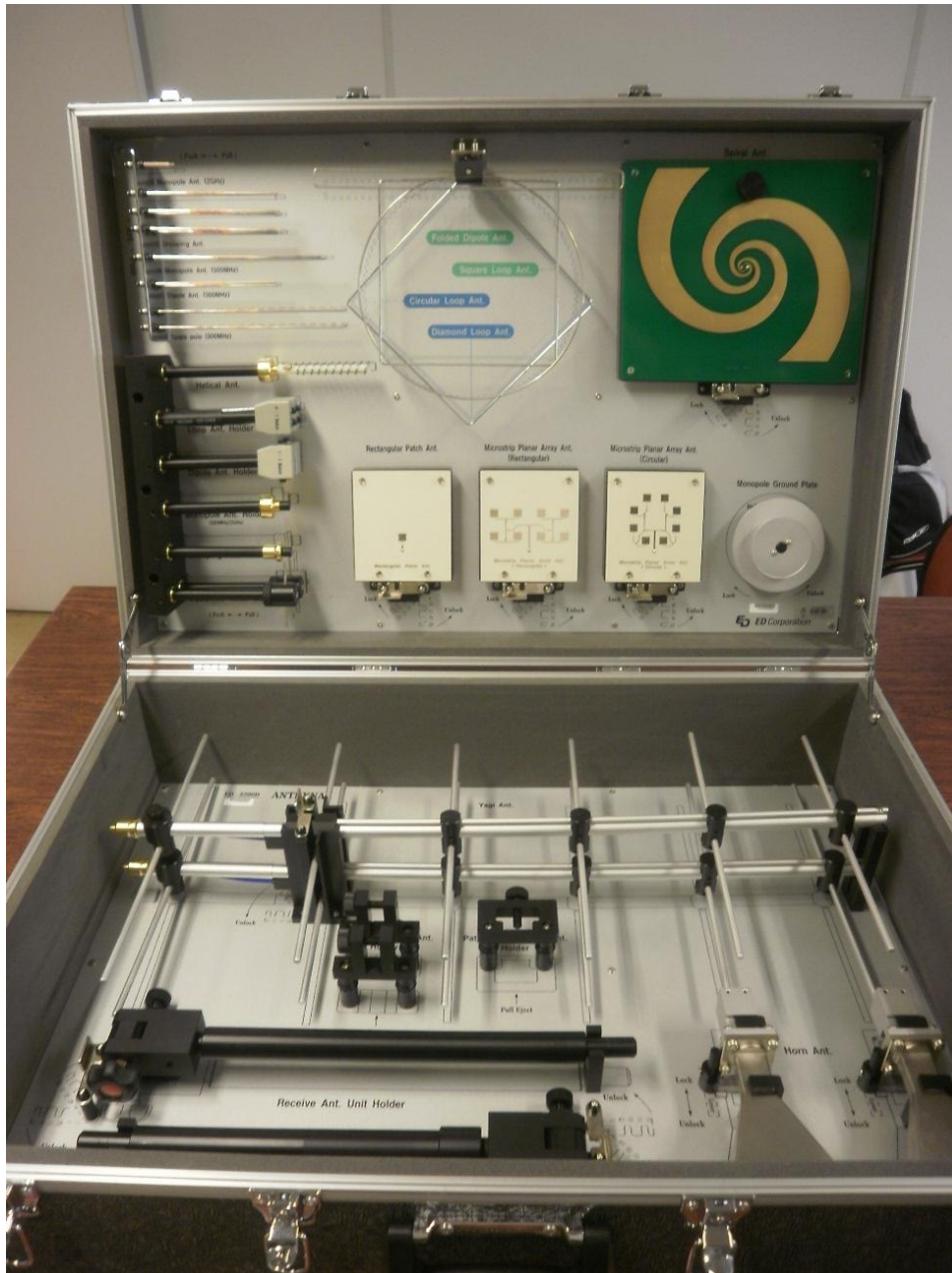
Figura 2.22. Disposição das antenas na caixa.
