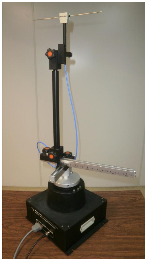
Figura 3.6. Antena dipolo de meia onda em polarização horizontal e alinhada com o eixo do rotor.
