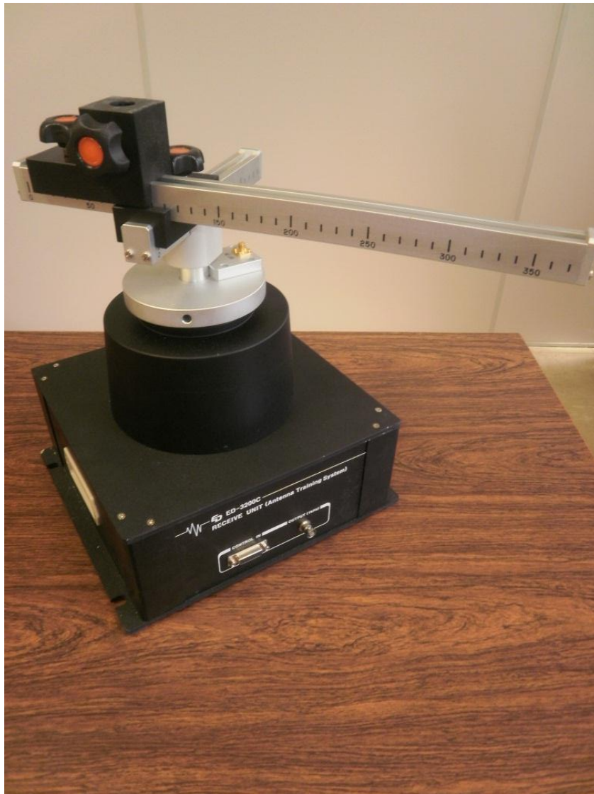
Figura 2.19. Base da unidade receptora.
