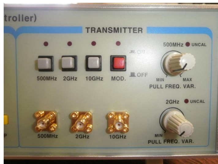
Figura 2.3. Detalhe do painel frontal do controlador principal responsável pela transmissão.
