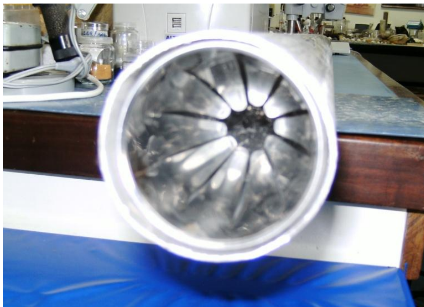
Figura 21 - Detalhe do sistema de retenção instalado na base do tubo de coleta para impedimento do escorregamento e mistura de camadas da amostra.
