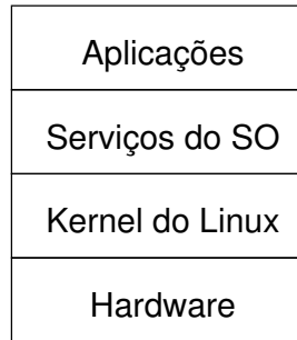
FIGURA 4.1 – Decomposição de um Sistema Linux em camadas principais
