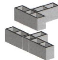
Figura 16: amarração no encontro de três paredes com módulo e largura diferentes, com uso de bloco especial de três furos (RAMALHO; CORRÊA, 2003, p. 21)
