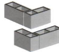
Figura 14: amarração com modulação e largura diferentes, com uso de bloco especial (RAMALHO; CORRÊA, 2003, p. 20)
