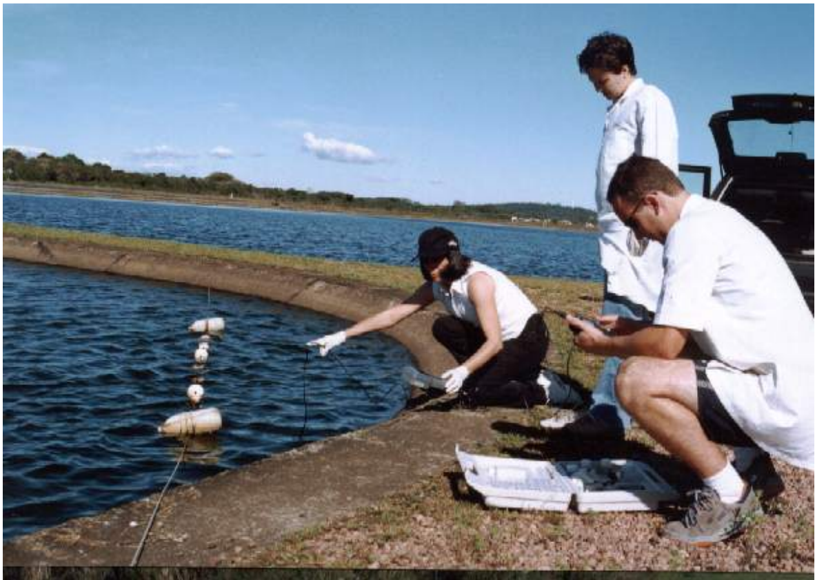
Fig. 1 Vista parcial das lagoas de estabilização da ETE Lami. Ponto de amostragem F na lagoa facultativa 1. Ao fundo lagoa de maturação 1.
