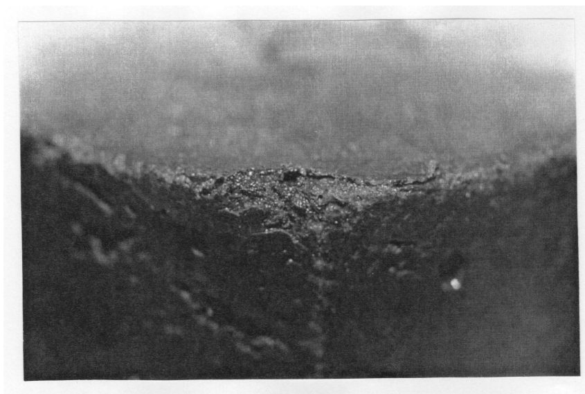
Figura 5.8 - Detalhe do lascamento superficial em um corpo-de-prova de concreto, de relação água/aglomerante de 0,42, com adição de CCA, após 120 dias de imersão em sulfato.
