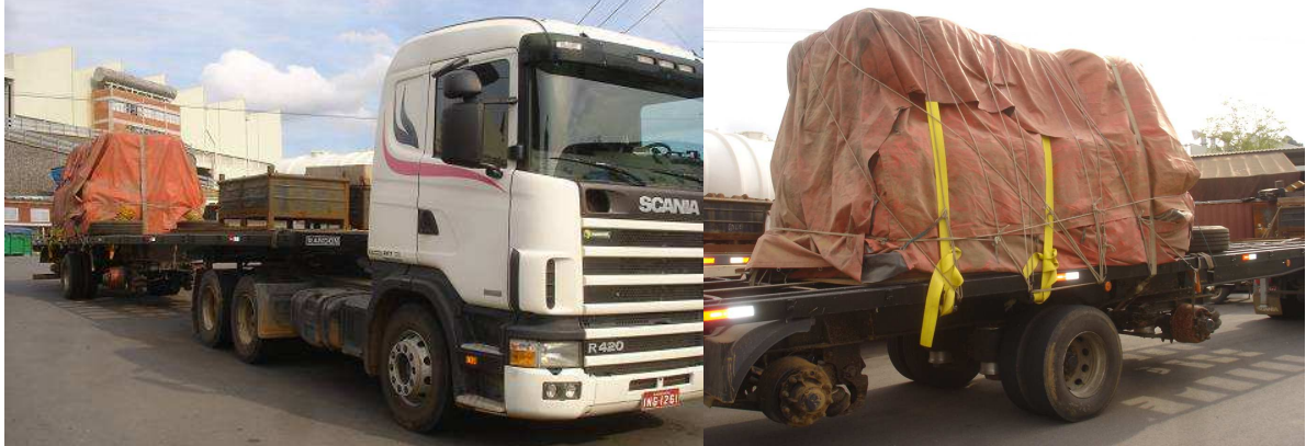
Figura 3.26 – Configuração utilizada no ensaio para validação do modelo da suspensão
