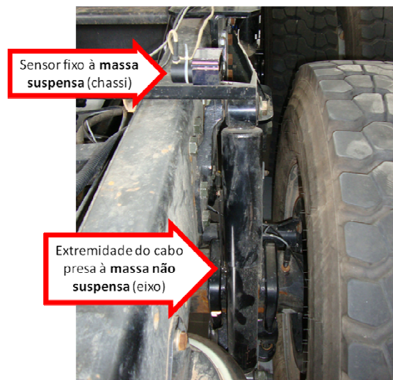
Figura 3.29 – Posicionamento de sensor para medição de deslocamento em extremidade de eixo
