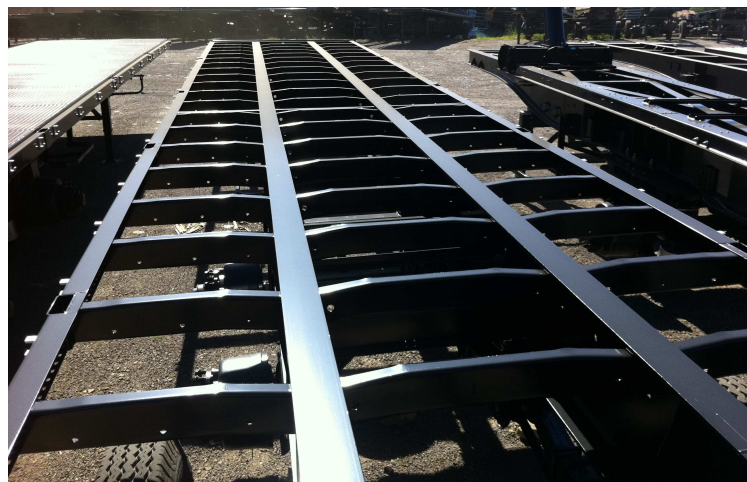
Figura 2.5 – Chassi de implemento rodoviário para transporte de granel
