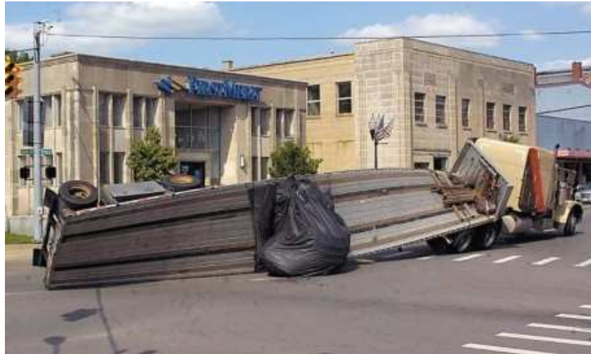
Figura 1.8 – Acidente em que a flexibilidade do semirreboque teve papel fundamental no comportamento dinâmico do conjunto veicular
