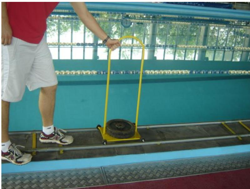
**Figura 9.** Trilhos e carrinho com suporte para câmera sub-aquática posicionados na borda lateral da piscina, utilizados para a análise da duração das fases e coordenação braçada-pernada.
