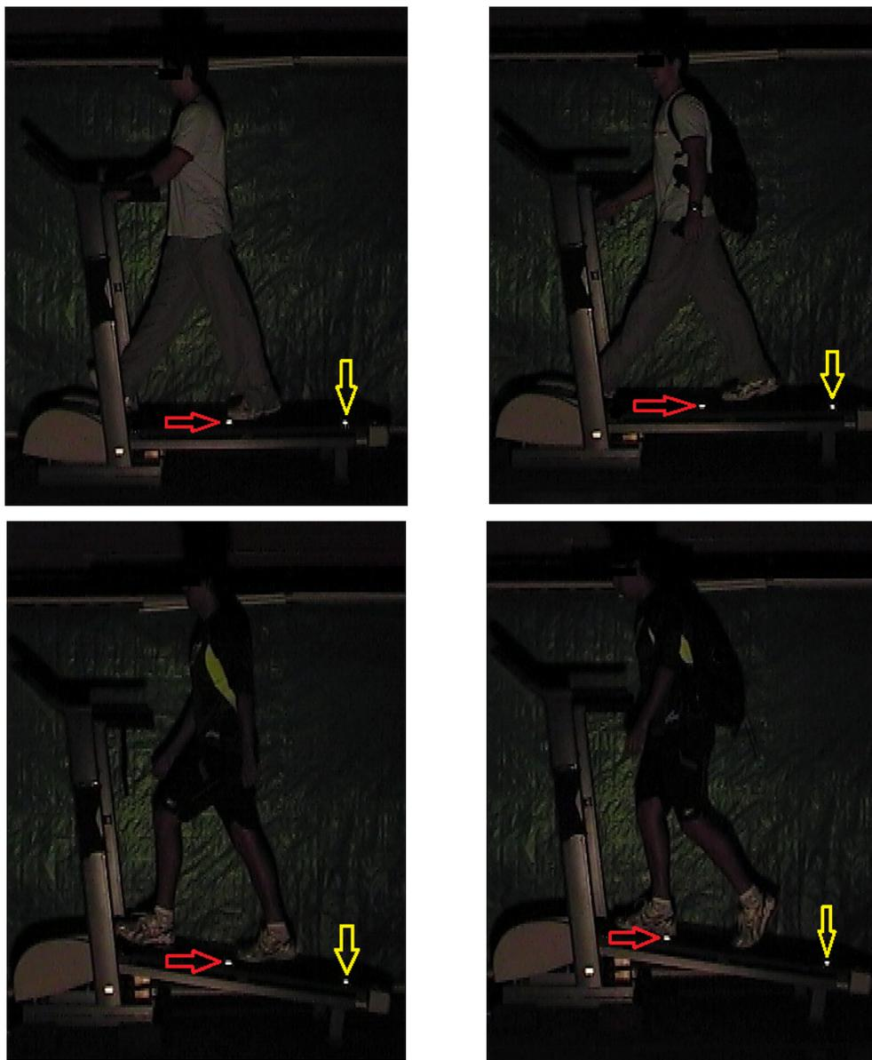
**Figura:** Coleta da Velocidade Real da Esteira Rolante. Diferentes velocidades de caminhada com e sem carga. **Acima:** caminhadas no plano. **Abaixo:** caminhadas a 15% de inclinação. **Setas Amarelas:** indicam a posição do marcador indicador. **Setas vermelhas:** indicam o sentido e deslocamento do marcador da esteira rolante.
