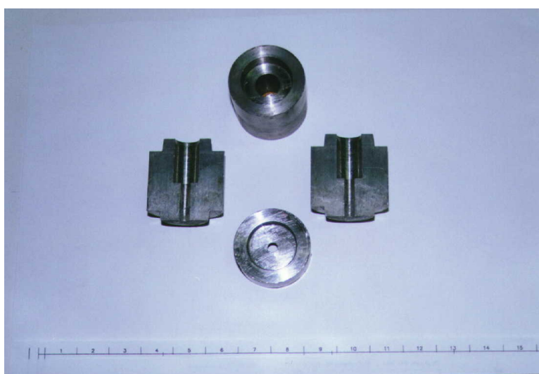
Figura 3.5.2. - Matriz destinada à injeção da carga injetável de corpos de prova de compressão.
