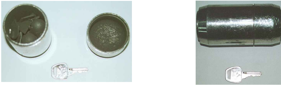
Figura 3.2.4 - Moinho de bolas usado para a cominuição das amostras.
