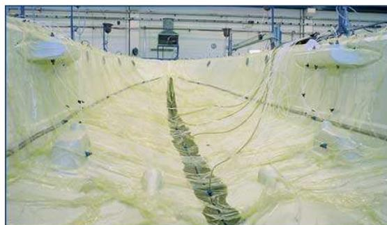
Figura 3: Moldagem de compósito pelo processo de infusão [12].
