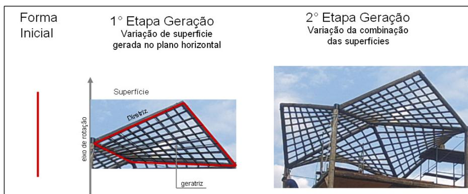
**Fig. 18. Esquema de processo de composição tridimensional. Montagem do autor a partir de fotos de cobertura do edifício experimental na USP/SC. Fotos cedidas ao autor pelo LaMem.**
