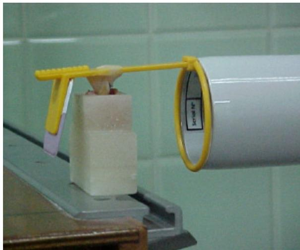
FIGURA 2: Tomada radiográfica inicial, com angulação vertical de 0°.
