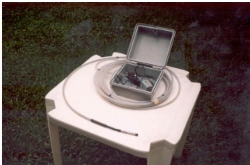
Fig. 5.7 – Sistema de aquisição automática de dados de pressão de água (piezômetros ou medidores de nível d'água).
