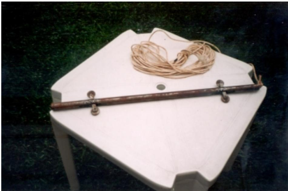
Figura 5.2 – Inclinômetro cego (*Dummy*) construído para se certificar de que o aparelho não tranca no tubo.
