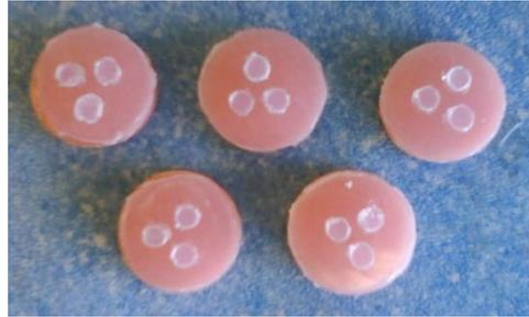
**Figura 1** Corpos de prova cilíndricos de EVA de 3mm de diâmetro e 3mm de espessura unidos à placa de EVA, representantes do Grupo 3 (Gcian)
