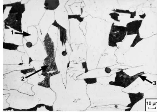
Figura 29 - (1) ferrita idiomórfica; (2) agregados de ferrita e carbonetos; (3) perlita degenerada. (Thewlis 2004).
