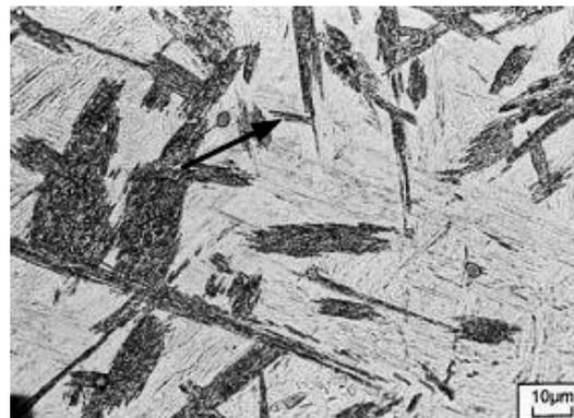
Figura 62 - Crescimento de feixes de bainita (seta) e nucleação simpática de ripas num aço 0,38% C, 1,39% Mn, 0,039% S, 0,09% V, transformada isotermicamente, 45s à 400 ° C. (Thewlis 2004).
