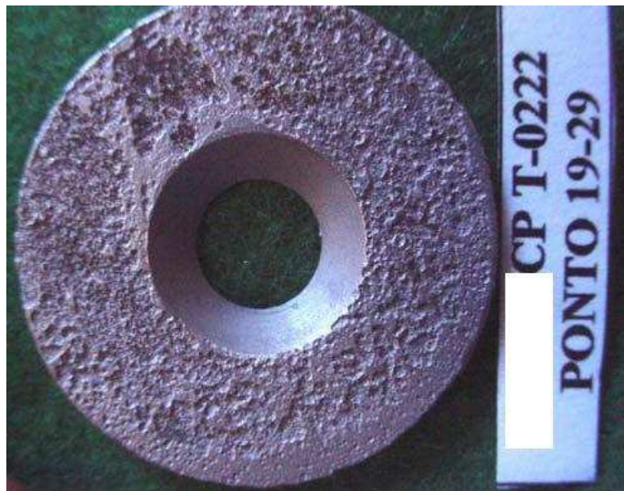
Figura 2.7 - Aspecto de cupom de perda de massa retirado e preparado para análise. [25]
