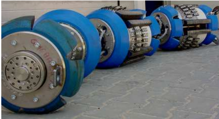
Figura 2.13 – Exemplo de pig com o emprego de tecnologia do tipo MFL [25]
