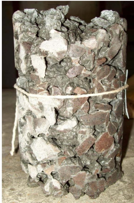
Figura 5.7: Corpo-de-prova extraído com defeito na borda devido ao processo de extração. (Fonte: Arquivo do pesquisador)
