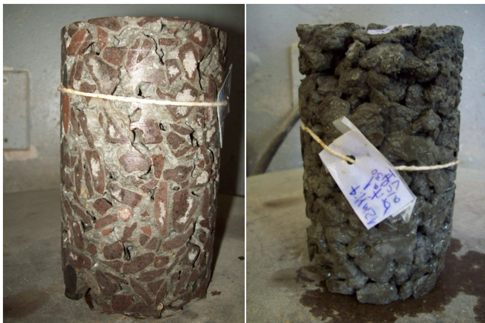
Figura 5.12: Comparação entre o acomodamento da brita entre um cp moldado e um extraído (Fonte: Arquivo do Pesquisador).
