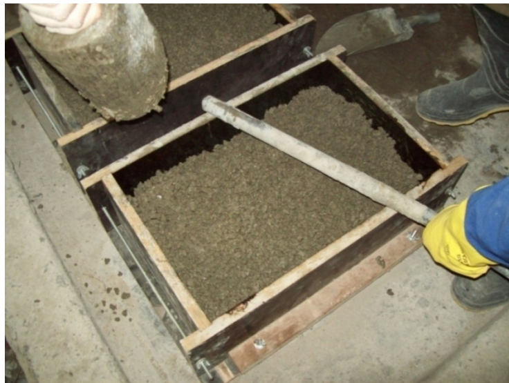
Figura 4.8: Vibração com vibrador do tipo agulha com diâmetro de 25mm. (Fonte: Arquivo do Pesquisador)
