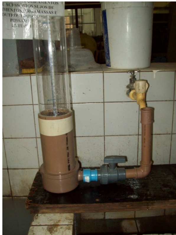
Figura 4.10: Aparelho construído para medição da condutividade hidráulica das amostras de concreto permeável. (Fonte: Arquivo do pesquisador)
