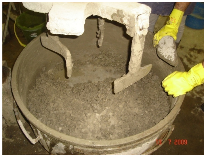
Figura 4.2: Aspecto da massa do concreto de um traço com relação a/c de 0,26. (Fonte: Arquivo do Pesquisador).
