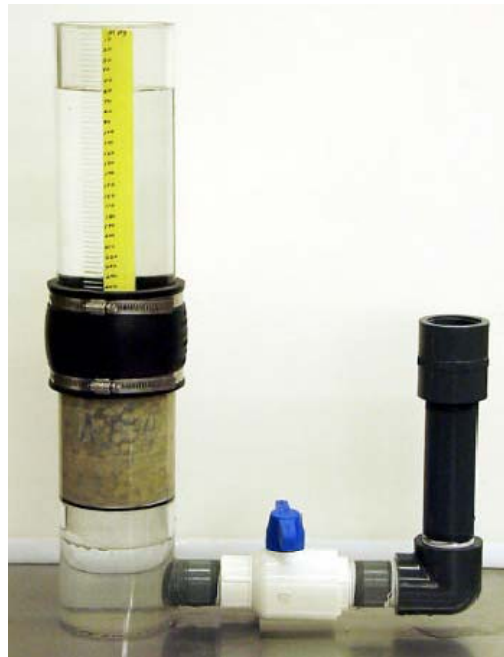
Figura 4.9: Vista do aparelho proposto para medição da condutividade hidráulica de concretos permeáveis (Fonte: Neithalath et al. , 2003).
