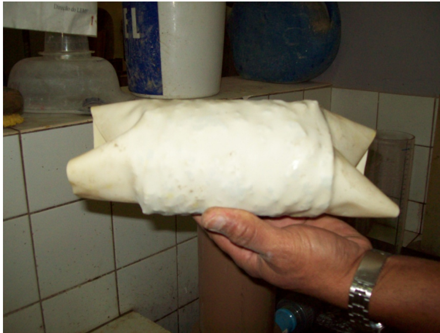
Figura 4.11: Corpo de prova encamisado com faixa látex. (Fonte: Arquivo do pesquisador)
