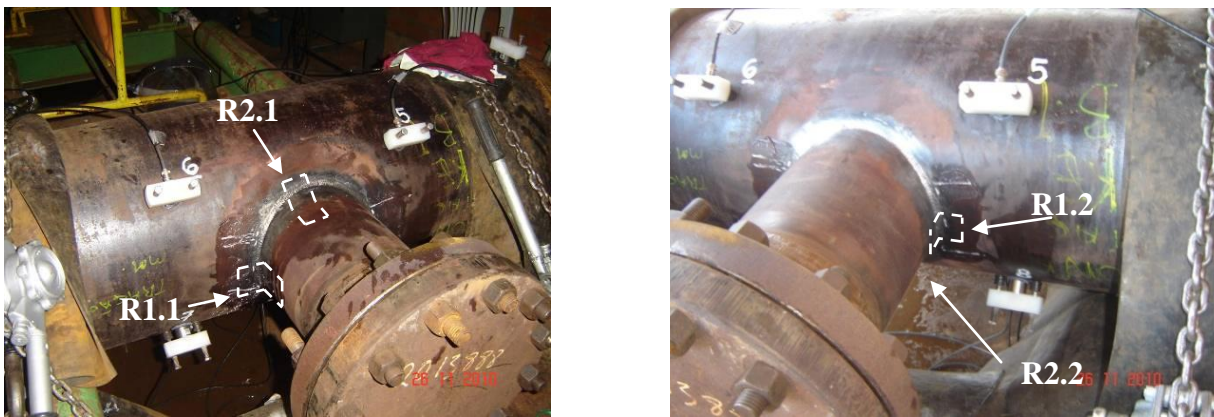
Figura 5.44 – Localização de amostras retiradas que foram analisadas com auxílio de microscópio óptico
