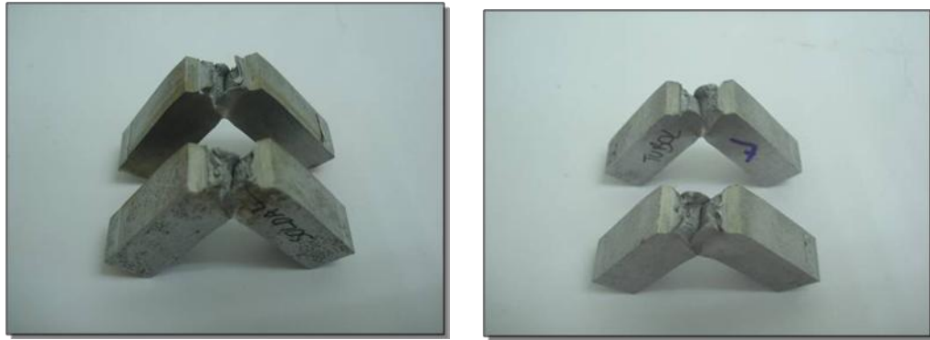
Figura 5.5 – Vista do aspecto dos corpos de prova após o ensaio de Charpy lado esquerdo corpos de prova soldados e na direita corpo de prova do tubo
