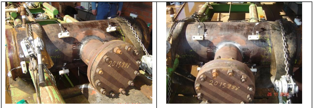
Figura 5.20 – Vistas mostrando localização dos sensores durante o teste hidrostático
