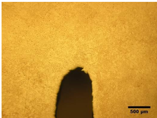
Figura 5.14 – Vista da extremidade da fissura de um corpo de prova SENT com 50x e 200x, onde é observado que extremidade da fissura teve o processo de embotamento, porém não tem propagação da trinca
