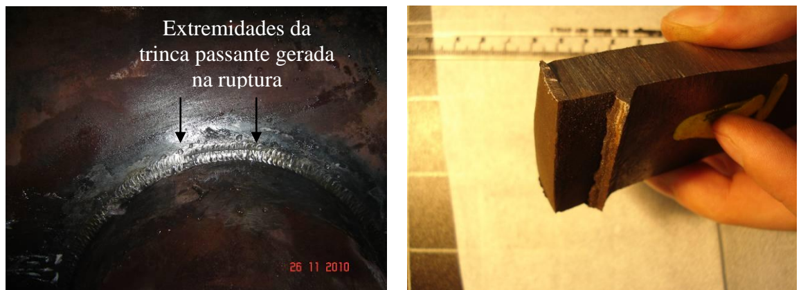
Figura 5.47 - Amostra da região R2.1 observa-se que houve grande deformação plástica na superfície da qual a trinca é nucleada, embotamento e propagação onde a descontinuidade propagou aproximadamente 300 µm; Esquerda ampliação 50X e direita ampliação de 200x; Ataque Nital 2%
