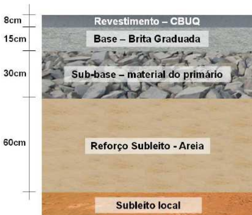
Figura 5: Estrutura do pavimento considerada nesta pesquisa (VICTORINO, 2008)
