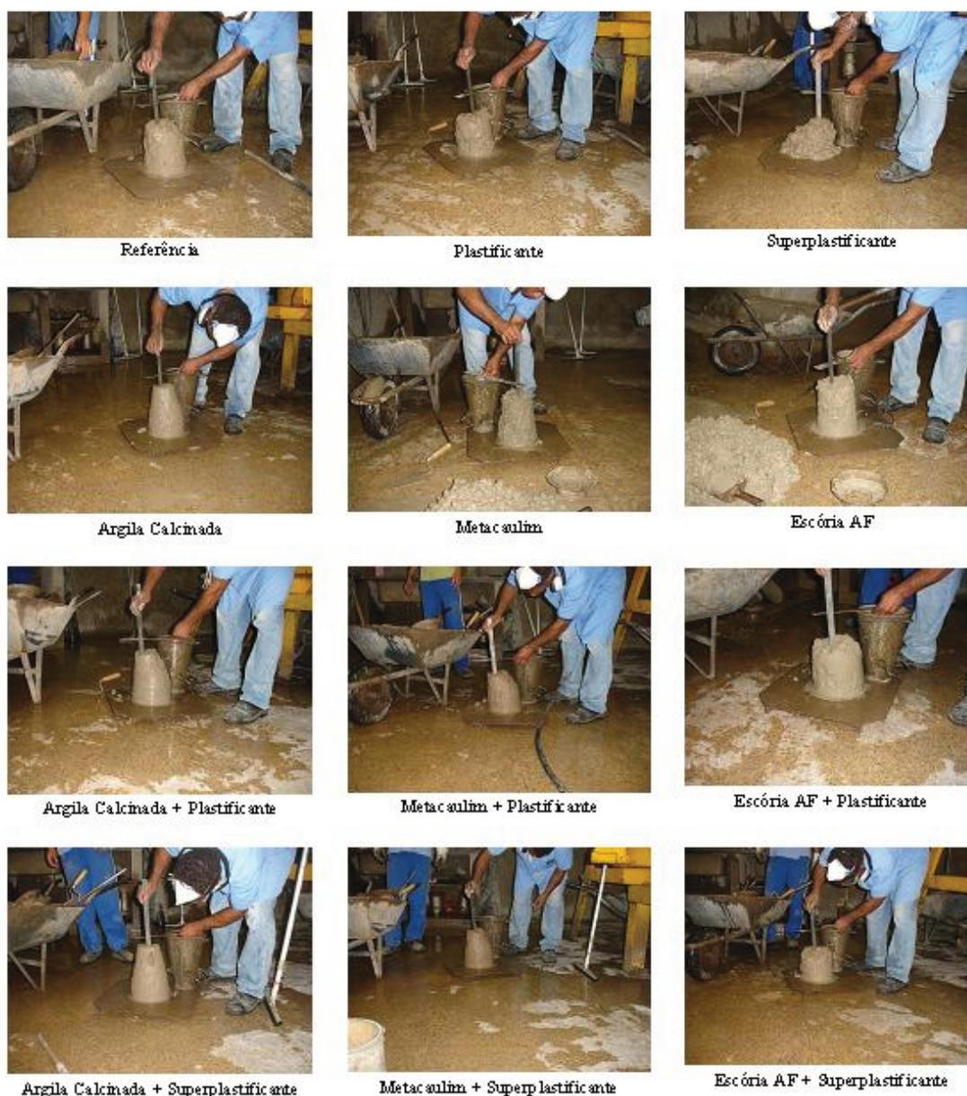
Figura B.1: Abatimento do tronco de cone (*Slump*) de todas as combinações testadas.
