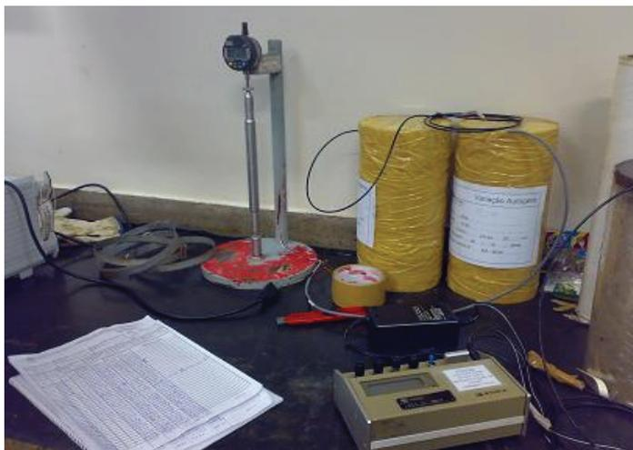
Figura A.10: CP's para ensaio de retração autógena sobre uma bancada.
