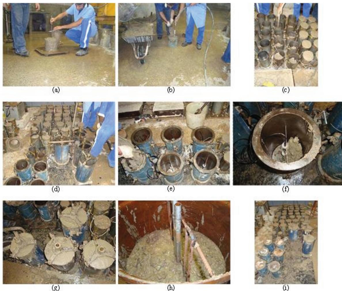
Figura 5.1: Moldagem da dosagem de referência: (a) Abatimento; (b) Ensaio de ar aprisionado; (c) Moldagem dos CP's 15x30cm; (d) Vista geral das moldagens; (e) Moldagem dos CP's de fluência; (f) Detalhe da moldagem com extensômetro embutido; (g) Moldagem dos CP's das propriedades térmicas; (h) Moldagem do CP da adiabática; (i) Final das moldagens.
