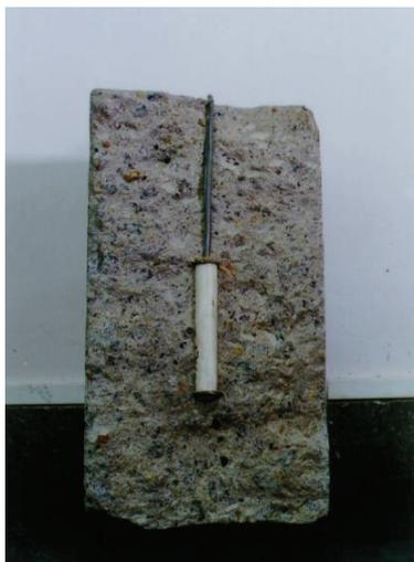
Figura A.15: Extensômetro Embutido Tipo *Carlson* (EQUIPE DE FURNAS, 1997).
