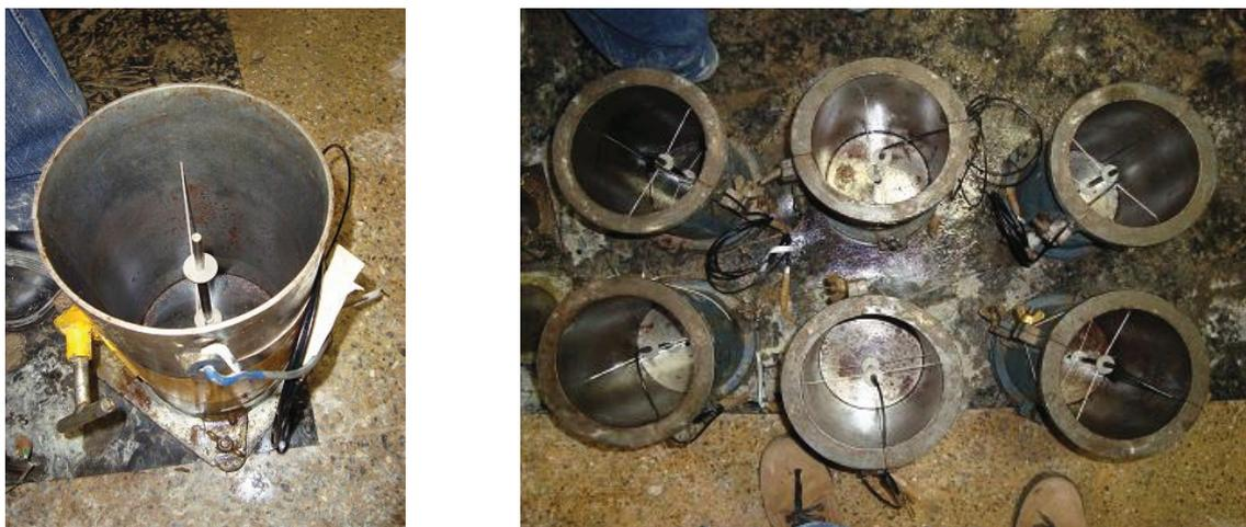
Figura A.9: Posicionamento dos extensômetros óticos nos moldes para posterior moldagem dos CP's.
