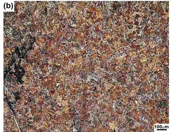
Figura 4.6 – Micrografias revelando a microestrutura do material analisado em baixa magnificação. (a) Amostra 1100-30-01, foto da região central; (b) Amostra 1250-30-2,5, foto da região central.
