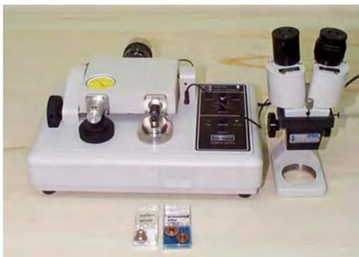
**Figura 3.7- Equipamento para preparação de amostras para MET “Dimple Grinder” modelo 656 marca Gatan.**
