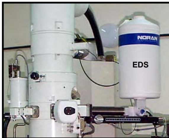
**Figura 2.23 – Esquema de funcionamento do sistema EDS (a) [20]; O sistema acoplado a um MET JEOL de alta resolução (b) [20].**
